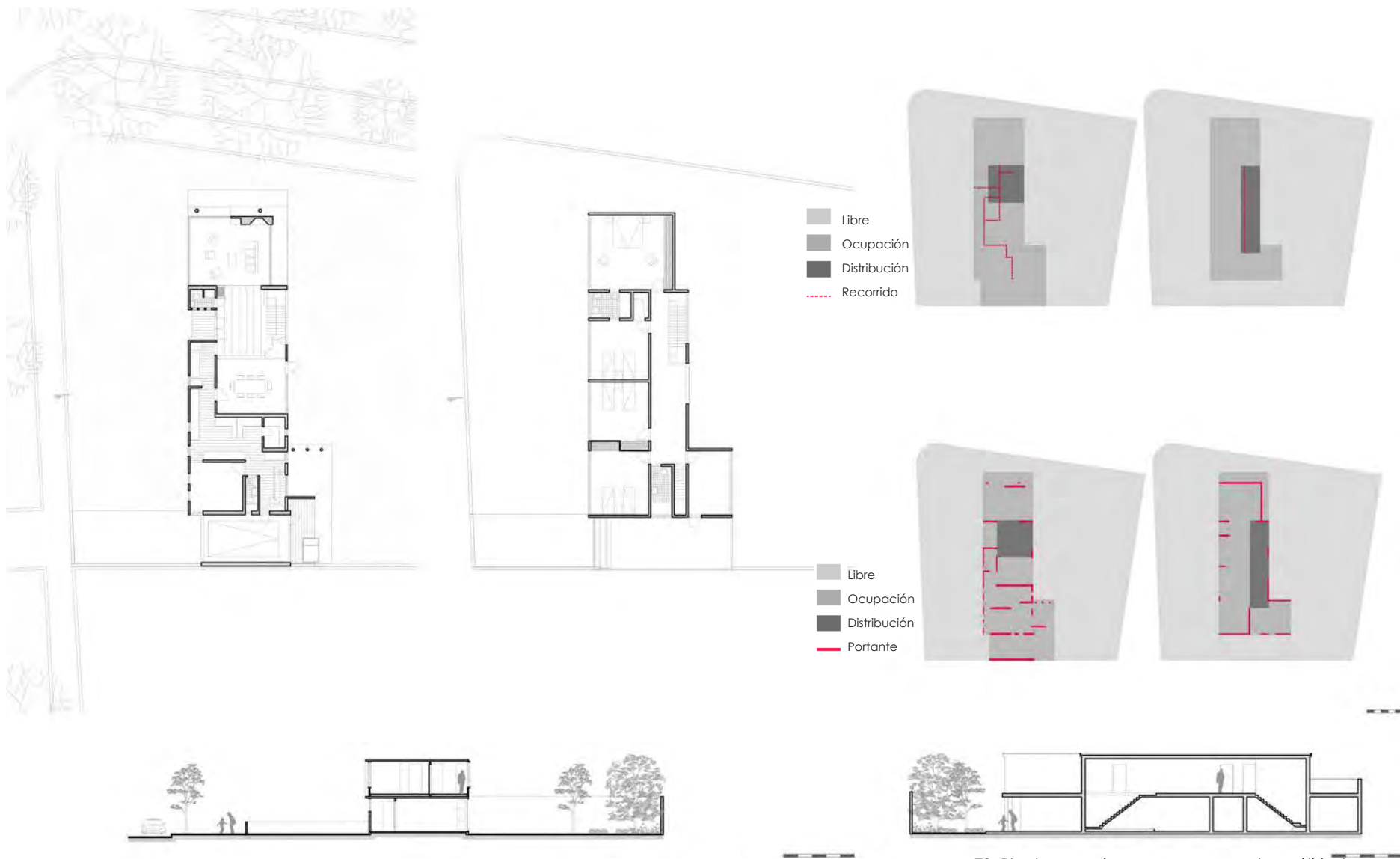
73. Plantas, secciones y esquemas de análisis de organización espacial y sistema portante casa Ochoa. Fuente: Elaboración propia
