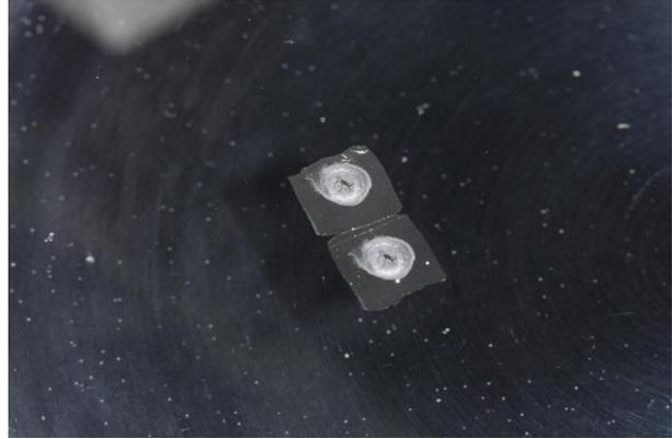
**Figura 79.** Muestras cortadas colocadas en agua destilada. **Figura 80.** Pescando las muestras para colocarlas en un portaobjetos
