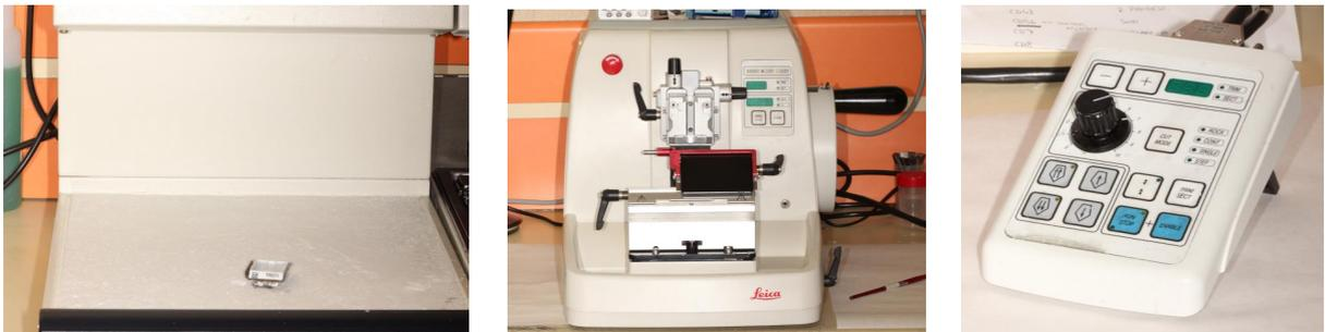
**Figura 74.** Bloque enfriándose a 3 °C. **Figura 75.** Micrótopo con el que se hacen los cortes. **Figura 76.** Graduador de las micras del micrótopo
