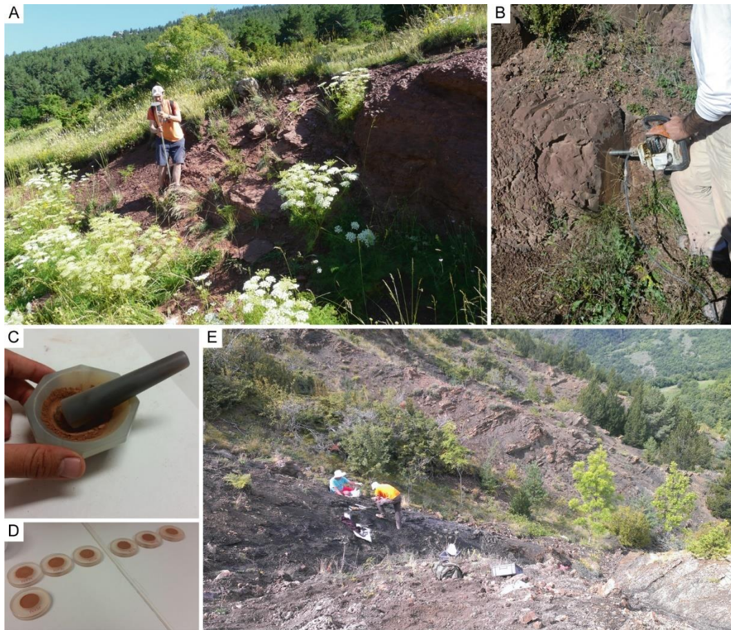
Figura 2.1. Recol·lecció de dades i mostres. A. Mesura de secció estratigràfica amb vara de Jacobs i brúixola. B. Perforació mecànica de la roca per obtenir una mostra per paleomagnetisme. C. Polvorització de mostra per DRX i FRX. D. Mostres de DRX i FRX preparades pels anàlisis. E. Excavació de plantes.
