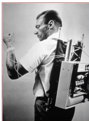
Figura 19: Prototipo de bomba portátil para infusión continua de insulina endovenosa desarrollado en la década de 1960.
