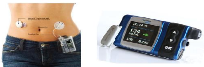
Figura 12. Sensores continuos de glucosa con visión en tiempo real integrados con ISCI (sistemas de Medtronic y Animas Vibe)
