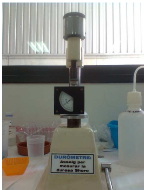
Imatge: 59 Detall del duròmetre utilitzat en l'assaig de duresa Shore dels films
