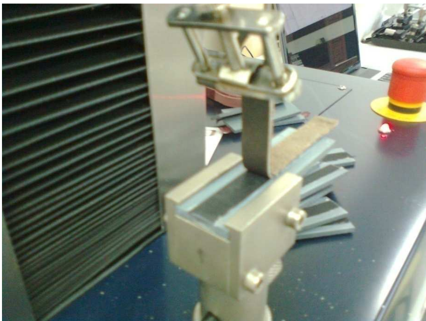
Imatge: 81 Detall de l'assaig de l'adhesió de l'acabat
