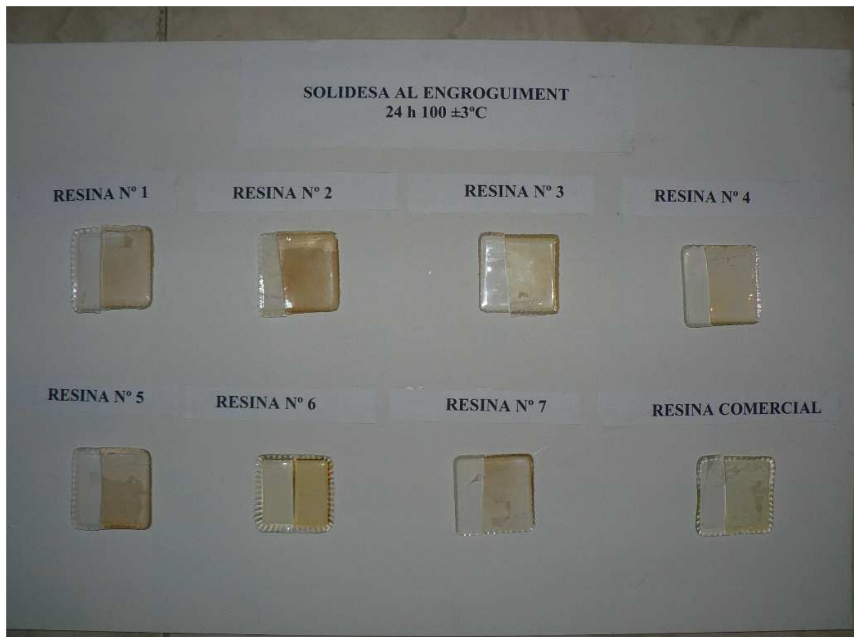
Imatge 27 Aspecte dels film abans i després d'assaig al calor
