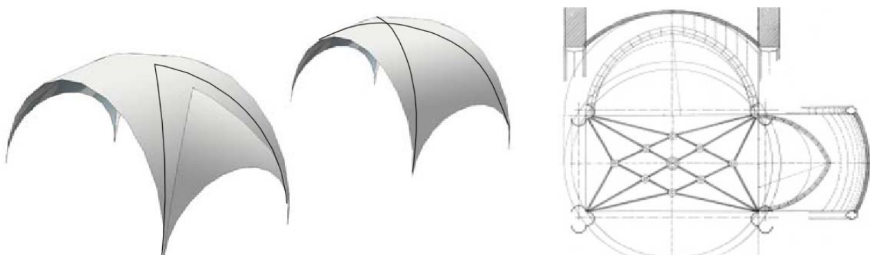
Fig.7 A l'esquerra volta de canó amb llunetes i volta d'aresta lleugerament peraltades. A la dreta volta d'aresta del gòtic tardà segons Huerta (Huerta, 2005).
