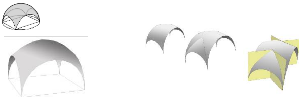
Fig. 75 Model de volta de mocador (esquerra). Dreta: Volta de mocador encaixada en tram rectangular i formació de llunetes.
