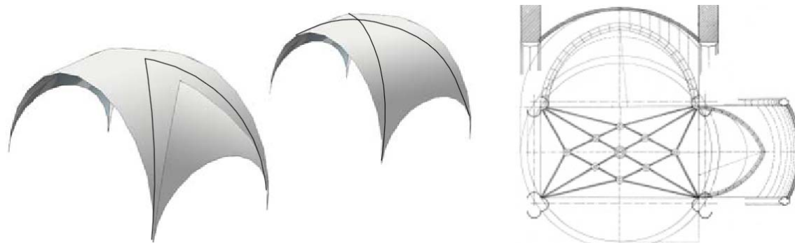
Fig.30 A l'esquerra volta de canó amb llunetes (les llunetes poden ser més o menys altes i la volta lleugerament peraltada. Al centre volta de mocador on es dibuixen les arestes "imaginàries". A la dreta volta d'aresta peraltada del gòtic tardà (Huerta, 2005)
