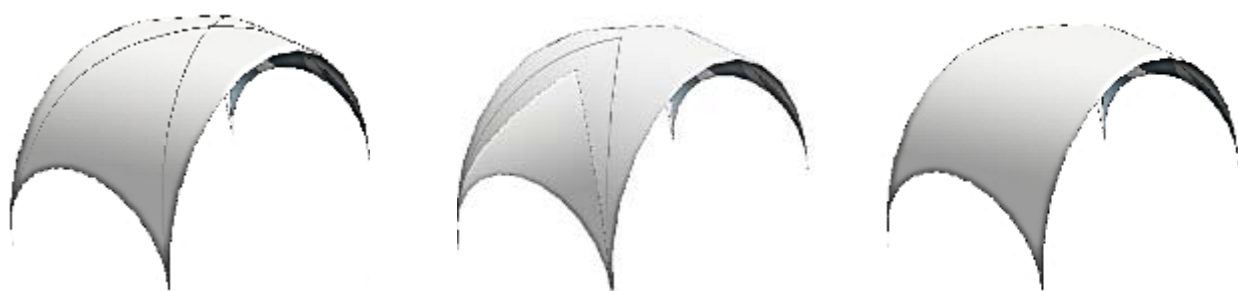
Fig. 83 Evolució de la volta peraltada de creueria sobre arcs de mig punt, cap a una volta peraltada de maó amb llunetes (permetent col·locar les llunetes a diverses alçades), fins a arribar a una volta de mocador.
