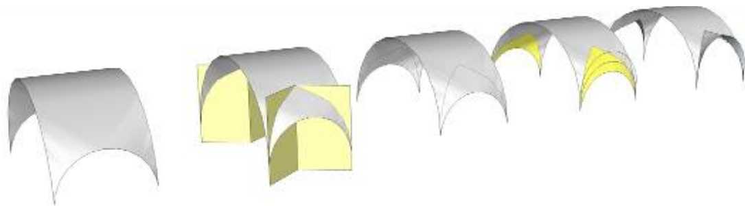
Fig. 63 Volta de canó on es formen les llunetes mitjançant plans verticals. L’arc former pot ser més o menys rebaixat, fet que genera diferents geometries de llunetes.
