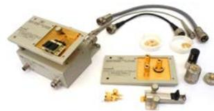
FIGURA B.5: Kit de impedancia Agilent® 43961A y la placa de adaptación 16092 de HewlettPackard® (Electrical Length 0.34 cm/ Máx 500 MHz)
