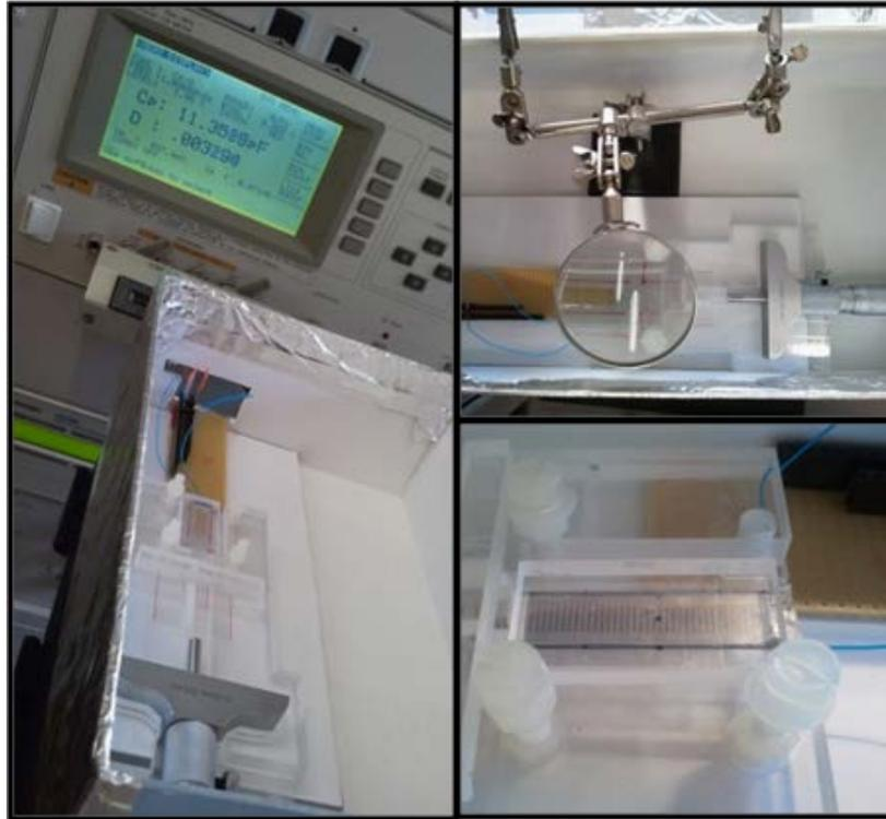
FIGURA 4.13: Banco de pruebas para la caracterización de la respuesta eléctrica de los IPPCs utilizando un LCRMeter
