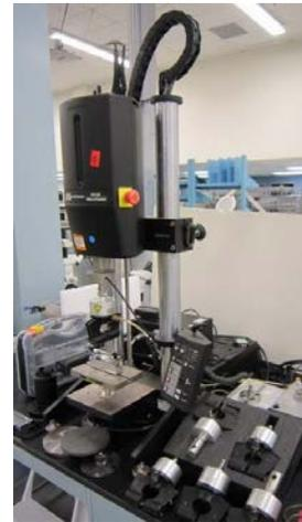
FIGURA B.9: Equipo de tracción uniaxial INSTRON<sup>®</sup> 5548 microtester con videoextensómetro.
