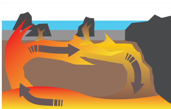
Figura 1.10. Esquema del modelo propuesto por la teoría de la convección impulsada por el borde. El cratón africano induciría una célula convectiva de pequeña escala responsable de un vulcanismo de patrón aleatorio y recurrente.
