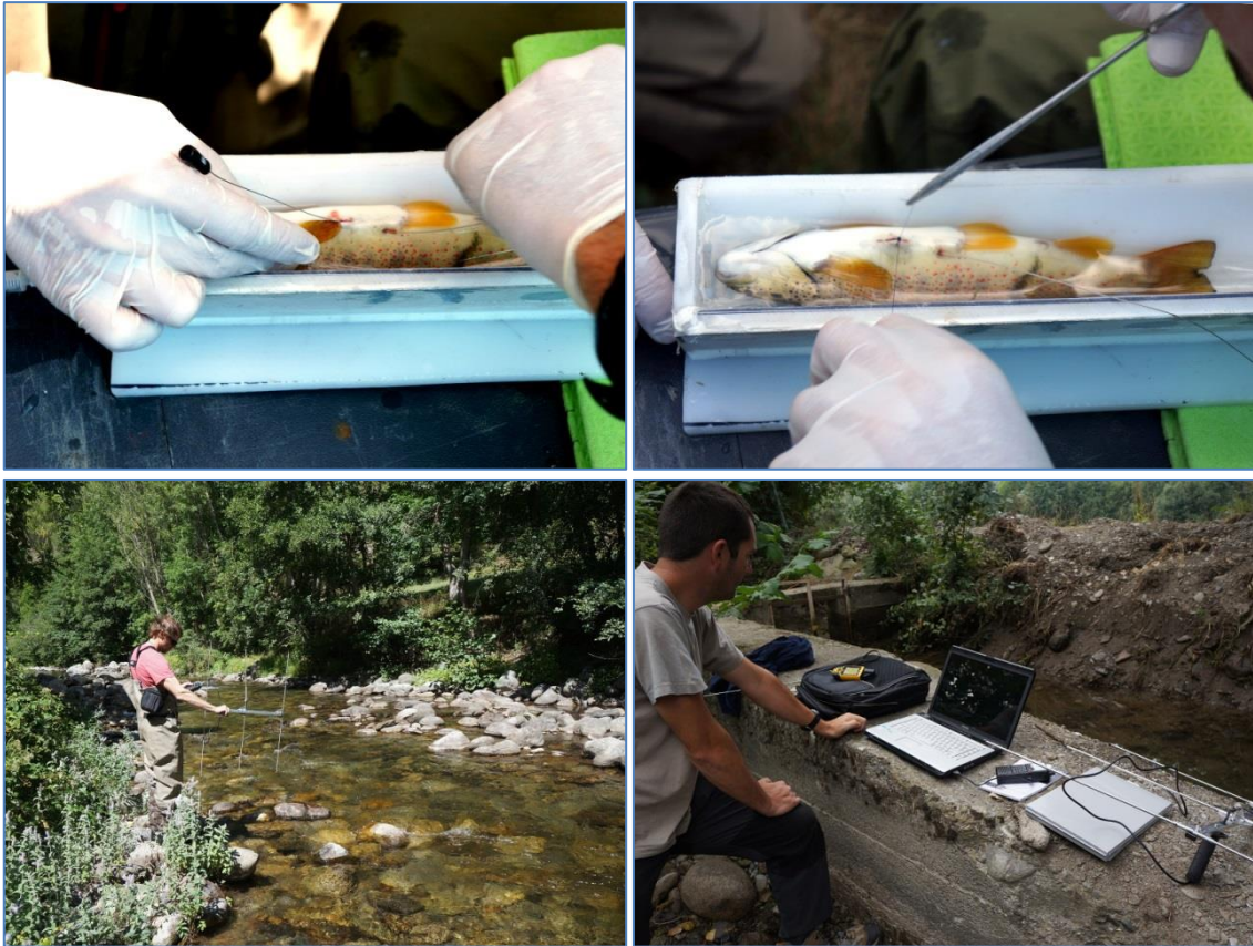
Figura 24. Implante de un transmisor de radiofrecuencia en la cavidad peritoneal de una trucha (arriba) y tareas de posicionamiento con un receptor ICOM RC20 y una antena Yagi de 3 elementos (abajo).
