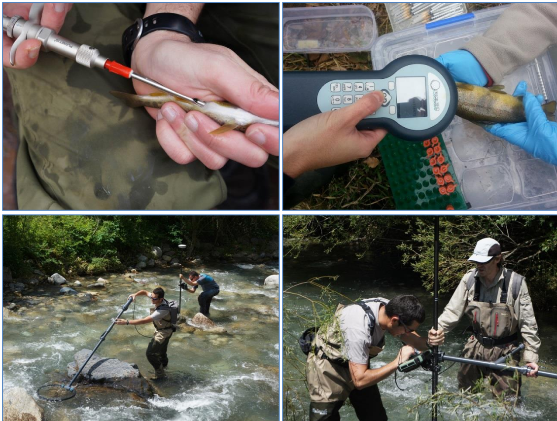
Figura 23. Implante de una PIT-tag en la cavidad peritoneal de una trucha y registro de códigos mediante un lector de PIT-tags manual. En la parte inferior se observan las tareas de posicionamiento con un lector portátil y un gps de precisión.
