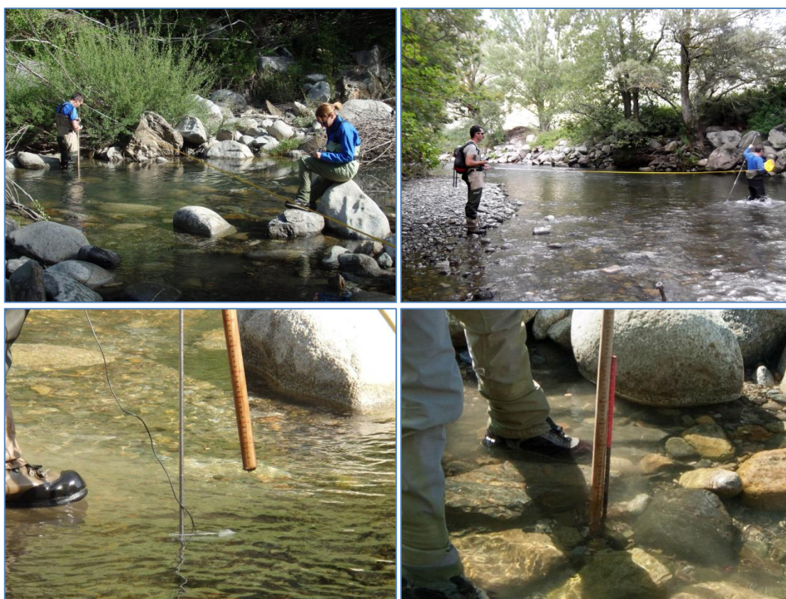
Figura 17. Tareas de caracterización de las unidades hidromorfológicas (arriba) y de medición de la velocidad y la profundidad de la corriente (abajo).
