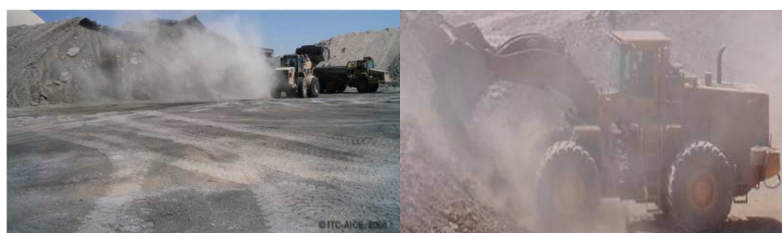
Figura 1.6 Emisiones difusas de PM generadas en operaciones de manipulación de sólidos pulverulentos
