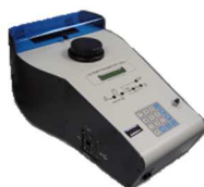
Figura 3.7 Picnómetro empleado para la medida de la densidad real del sólido
