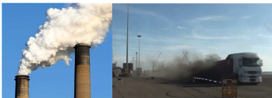
Figura 1.1 Fuentes industriales de PM: canalizadas (izq.) y difusas (dcha.)
