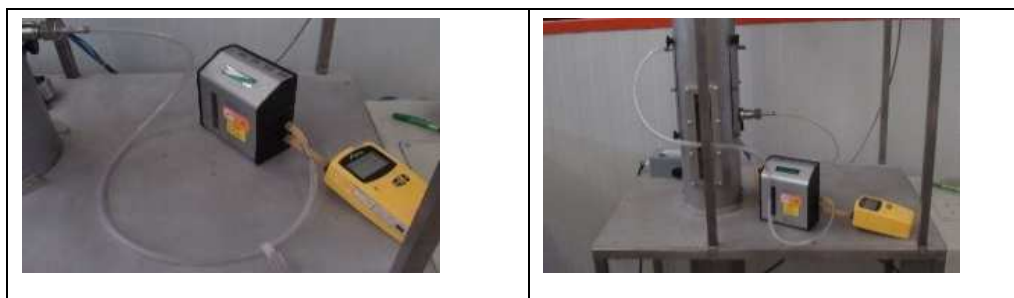
Figura 3.17 Ajuste de caudal, fracción inhalable (izq.) y fracción respirable (dcha.)
