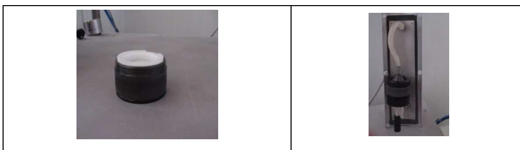
Figura 3.20 Colocación de los filtros en el cabezal de la fracción respirable
