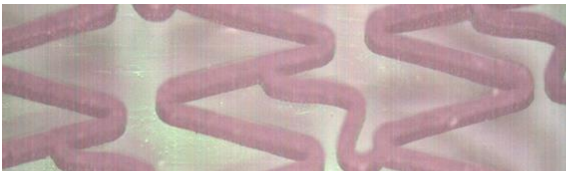
Figura 3-30 Adquisició unrolled a 40^\circ , no s'obté prou contrast degut a que torna molt poca llum procedent de l'epi-il·luminador.
