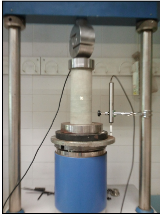
Figura 2.13 Montaje experimental para la determinación del módulo de elasticidad de la pizarra (testigo de 84mm de diámetro por 200 mm de altura)
