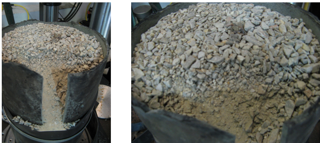
Figura 7.21 Visualización de rotura de partículas posterior al ensayo triaxial seco
