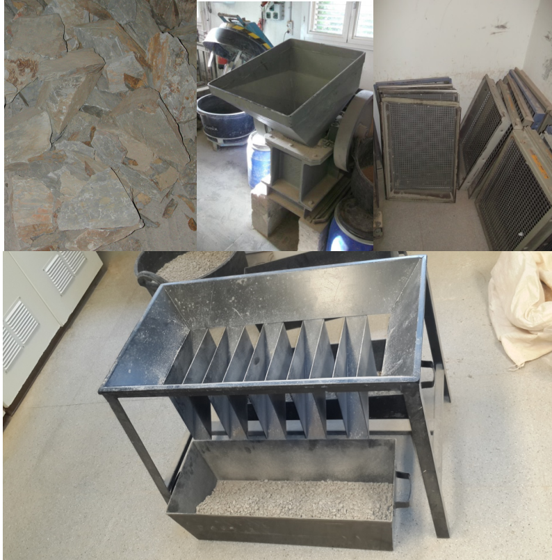
Figura 2.4. Preparación del material de grava de pizarra mediante trituración y tamizado
