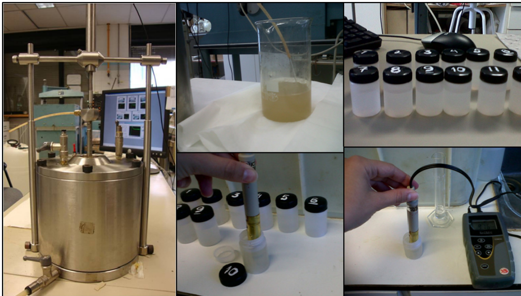
Figura 4.24 Toma de muestras del líquido drenado durante el reemplazo del fluido y medición de la conductividad eléctrica.
