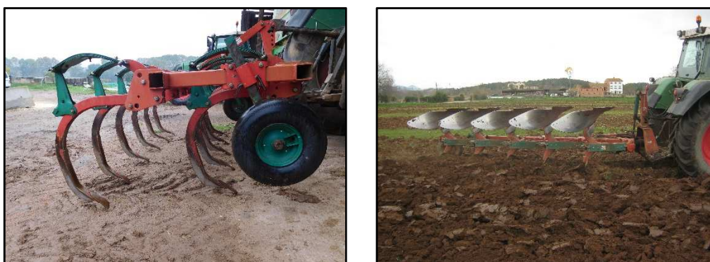
Figura 7. Izquierda: arado de cincel. Derecha: arado de vertedera.
