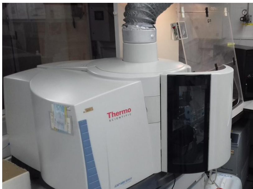
Figura 3.8. ICP-OES, Modelo iCAP 6000 Series de Thermo Scientific usado en el análisis de las muestras vegetales (Fuente: Francisco T. San Nicolás López, responsable del Servicio de Ionómica del CEBAS-CSIC, Murcia)
