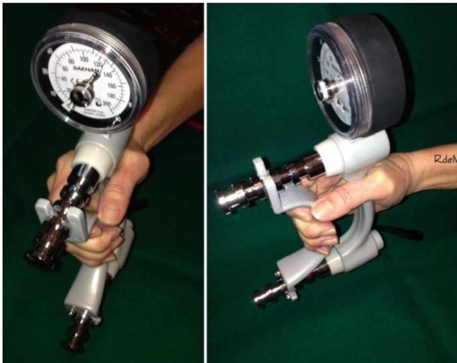
Figura 65: Dinamómetro hidráulico Jamar.
