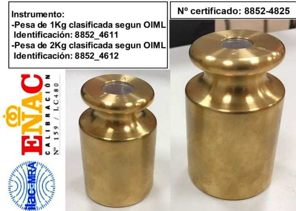
Figura 86: Pesas de calibración de 1 y 2 Kg y calibración.
