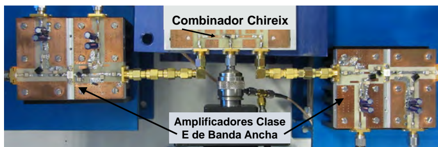
Figura VI.8 Fotografía del transmisor Chireix implementado, con detalle de los amplificadores y del combinador reactivo.
