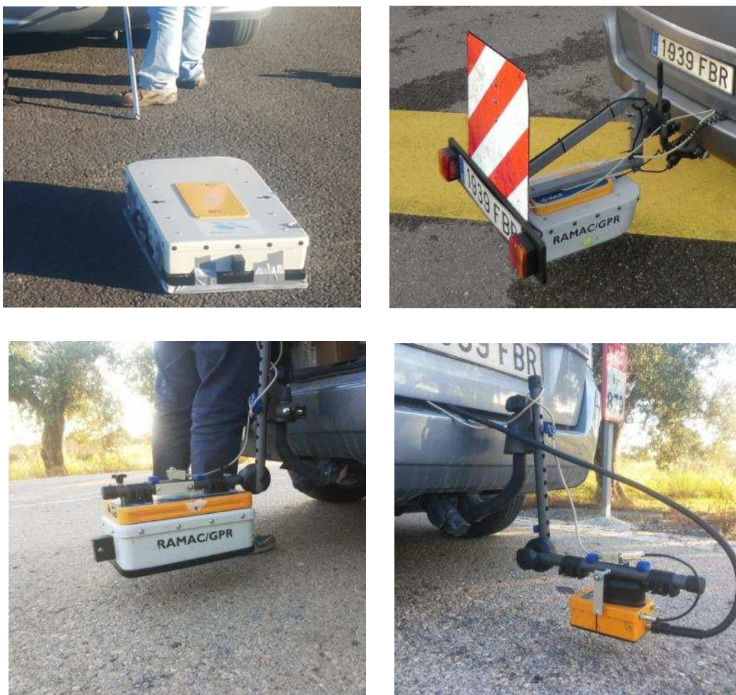
Figura 4.1: Antenas de 250 MHz (superior – izquierda), 500 MHz (superior – derecha), 800 MHz (inferior – izquierda) y 1200 MHz (inferior – derecha) utilizadas en los ensayos.
