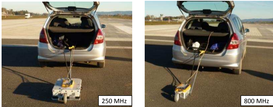
Figura 6.2: Equipo GPR con antenas de 250 MHz (izquierda) y 800 MHz (derecha).
