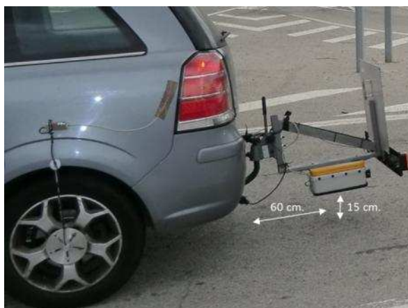
Figura 6.9: Dispositivo de GPR utilizado para los ensayos.
