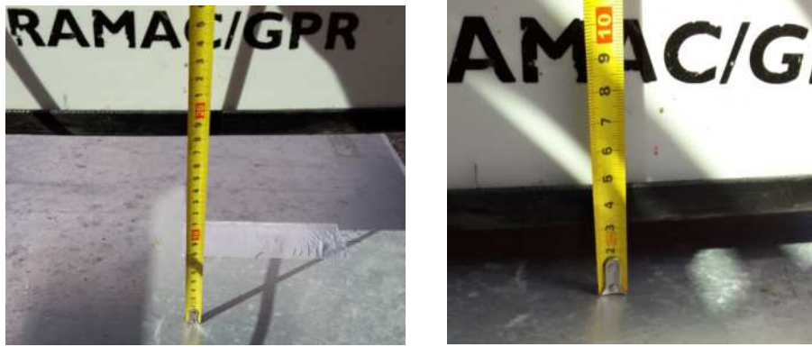
Figura 4.32: Ensayo con placa metálica desde 18 cm (izquierda) hasta 3 cm (derecha).
