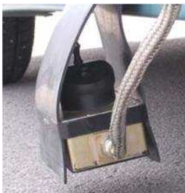
Figura 4.23: Antena de alta frecuencia de MALA Geoscience, en la puerta del vehículo.
