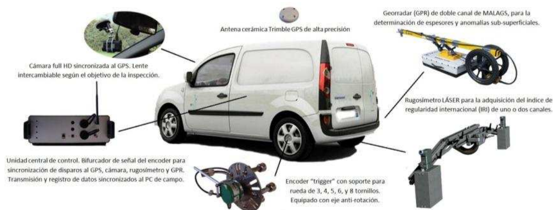
Figura 2.3: Elementos que pueden asociarse a un vehículo de inspección equipado con GPR
