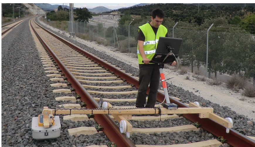
Figura 5.14: Dispositivo de medición con la antena de 500 MHz montada.
