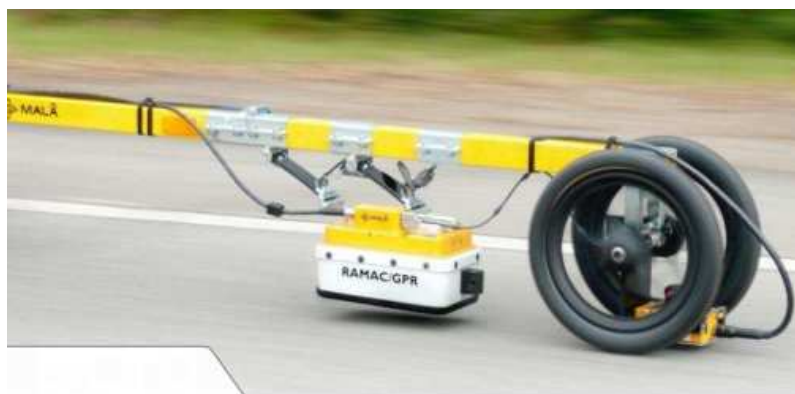
Figura 4.22: Carrito propuesto por MALA Geoscience para el transporte de antenas de GPR.
