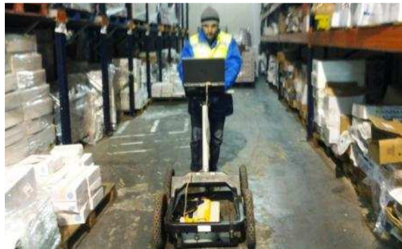
Figura 5.5: Ensayo con la antena de 500MHz en el recinto interior del almacén de ultra congelados.
