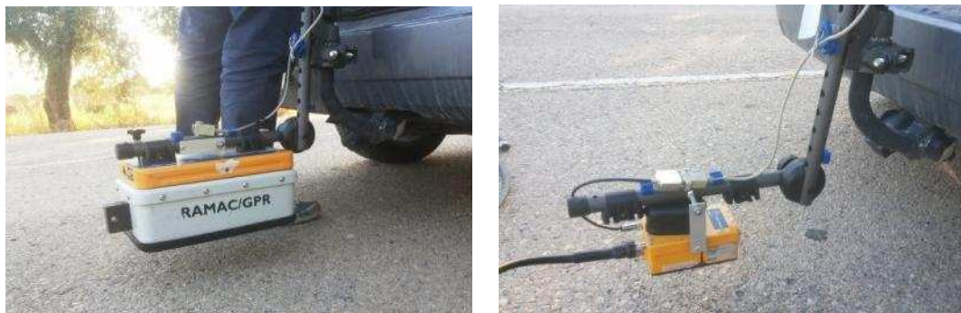
Figura 4.24: Dispositivo de soporte para el uso de varias antenas con altura variable.
