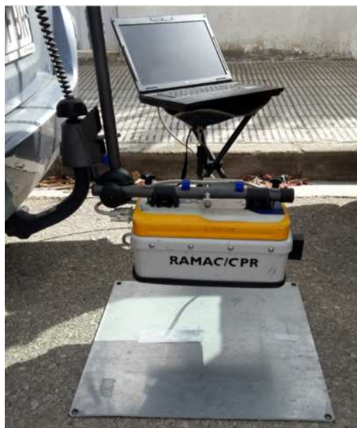
Figura 4.31: Dispositivo de ensayo con placa metálica en altura variable.
