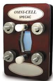
Figura 2.9: Célula medición FTIR líquidos. a) Fotografía b) Esquema de componentes (Fuente: www.speac.com )
