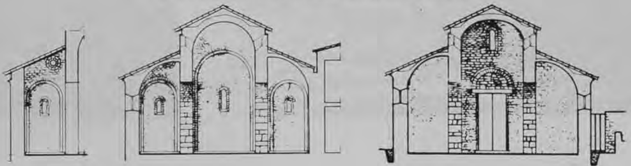
Sant Andreu de Sagàs. Seccions transversals de l'església, segons el projecte de rehabilitació redactat pels arquitectes Antoni Navarro i Joan-Albert Adell. El sector oriental de la nau lateral de tramuntana és cobert amb un sostrà pla, per tal de recuperar l'òcul, i els nivells de la primera coberta del temple (planimetria: Servei del Patrimoni Arquitectònic de la Generalitat de Catalunya).
