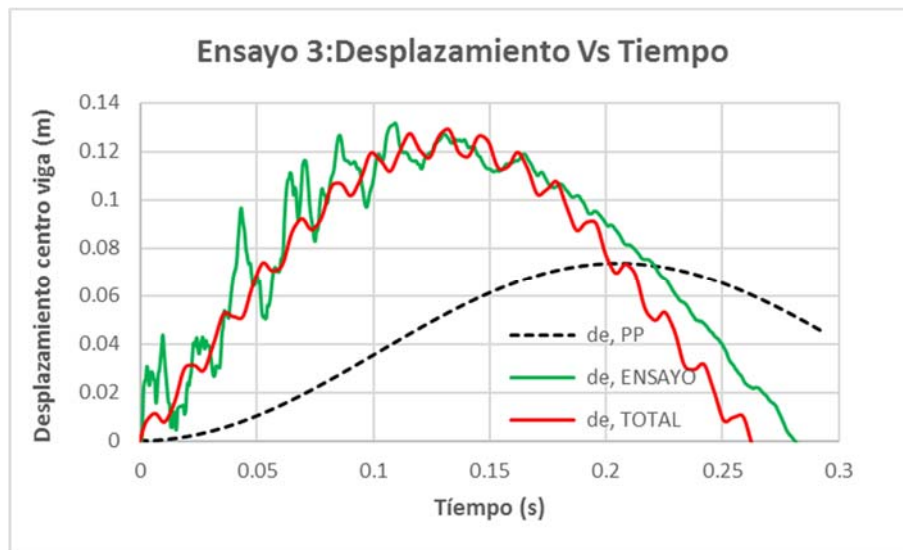
Figura 271- Registro desplazamiento-tiempo del centro de viga. Ensayo 3: \alpha=7.2 V=1.37 m/s.
