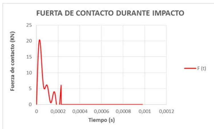
Figura 287- Fuerza de contacto para el ensayo 3. \alpha=0.21 y V=1.5 m/s.
