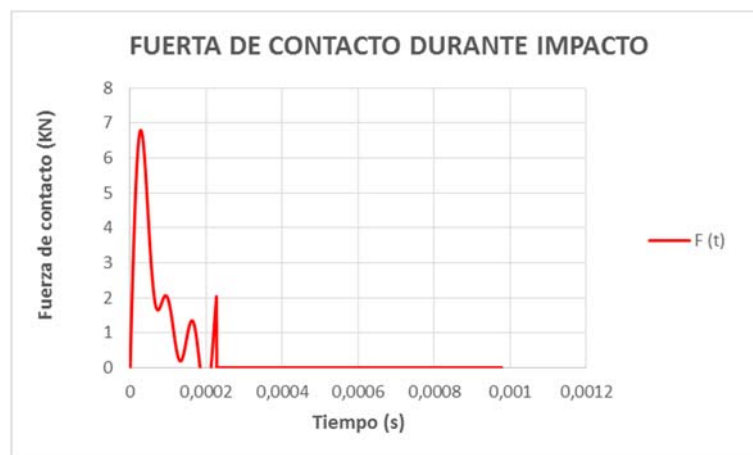
Figura 285-Fuerza de contacto para el ensayo 1. \alpha=0.21 y V=0.5 m/s.
