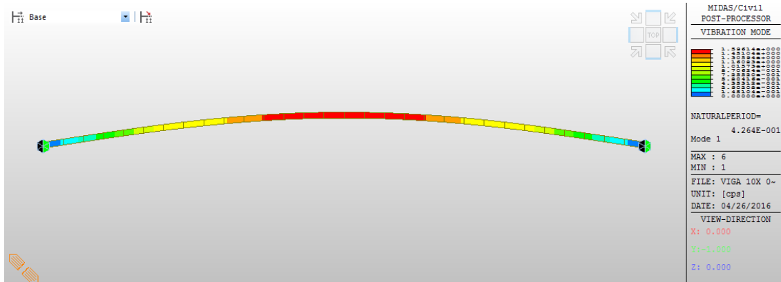
Figura 140-Modo 1 de Flexión. T=0.4264 s. Análisis multimodal.
