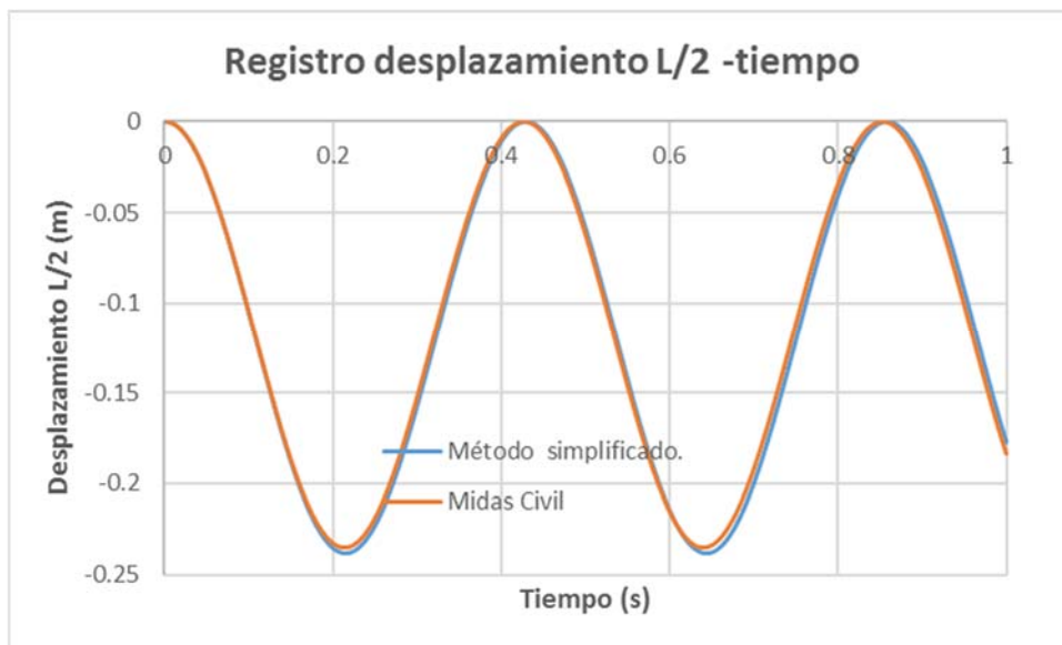
Figura 123-Desplazamiento del centro de luz para carga contante de 10 KN aplicada en centro de luz, mediante Midas Civil y mediante método simplificado.
