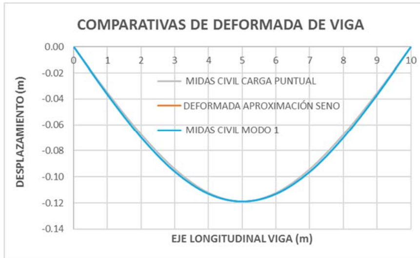
Figura 86-Comparativa gráfica de las deformadas de carga puntual calculada con Midas Civil y con el método aproximado y la deformada del primer modo de vibración calculada con Midas Civil.
