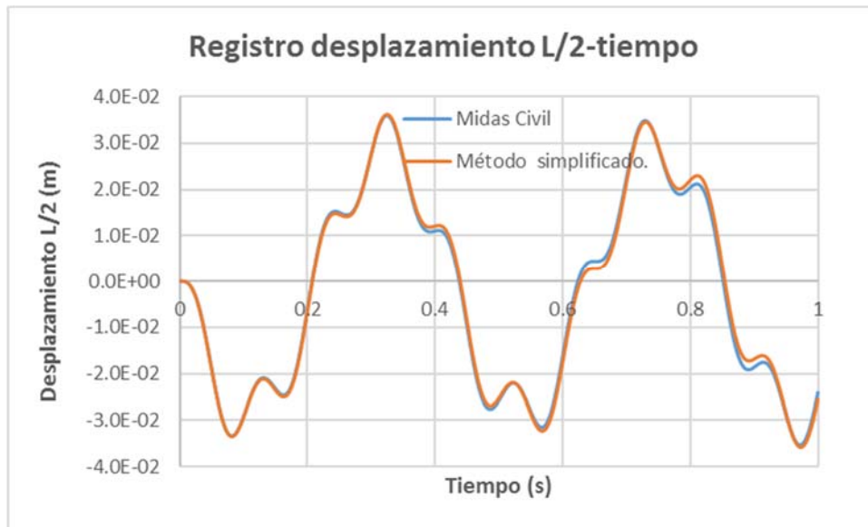
Figura 125- Desplazamiento del centro de luz para carga cíclica de 10 kN y de 10 Hz aplicada en centro de luz, mediante Midas Civil y mediante método simplificado
