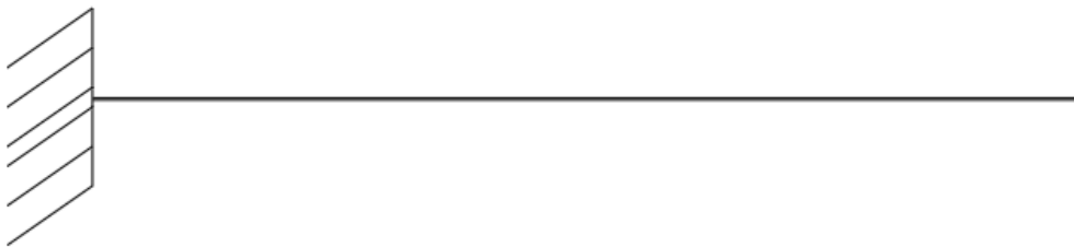
Figura 104- Ménsula sobre la que se calcula la rigidez del punto del extremo libre para el modo fundamental axial.
