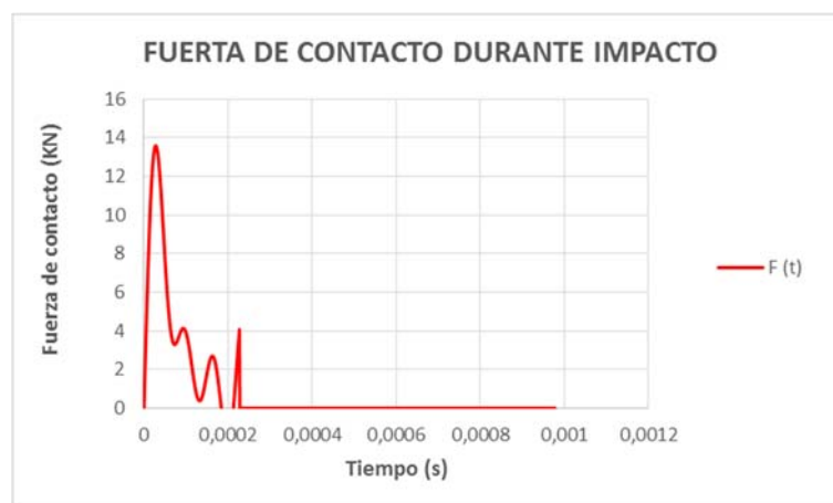
Figura 286- Fuerza de contacto para el ensayo 1. \alpha=0.21 y V=0.5 m/s.
