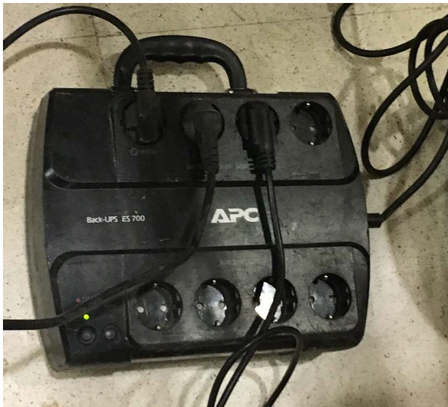
Figura 266-Sistema de alimentación ininterrumpida.
