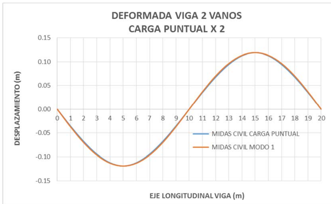
Figura 91- Comparativa gráfica de las deformadas de carga puntual calculada con Midas Civil y la deformada del primer modo de vibración calculada con Midas Civil para el caso de la viga de dos vanos.
