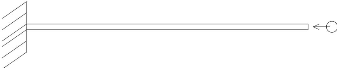
Figura 219- Caso de impacto axial en ménsula metálica.
