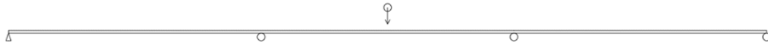
Figura 200- Esquema de impacto en el punto central del central en viga continua de tres vanos.
