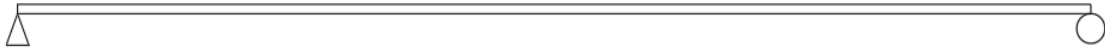
Figura 84-Viga biapoyada sobre la que se calcula la rigidez del punto central para el modo fundamental.
