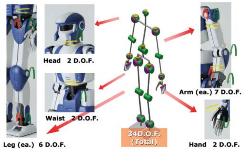
Figura 2.47: Configuración de los gdl del HRP-4 ((Kaneko, Kanehiro, Morisawa, Akachi, et al., 2011))
