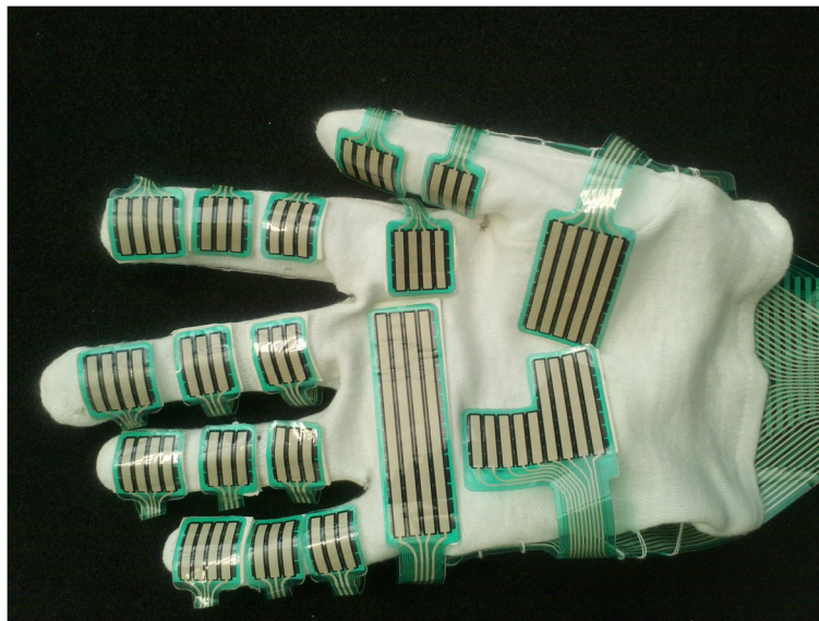
Figura 3.2. Sensor Grip 4256E cosido a un guante de algodón.
