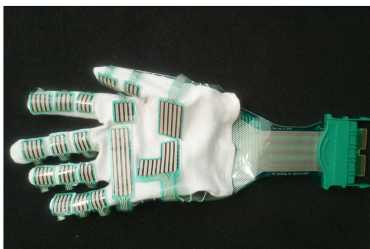
Figura 4.3. Sensor GRIP 4256E (TEKSCAN) montado sobre un guante de algodón.
