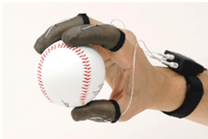
Figura 2.59: Sensor Finger TPS (Pressure profiles Systems, Los Angeles, CA) instrumentado en una mano derecha
