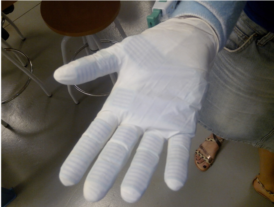
Figura 6.3: Sensor Grip 4256-E (Tekscan, Inc.) cosido a un guante de algodón y recubierto por un guante de LDPE y otro de látex para fijarlo.
