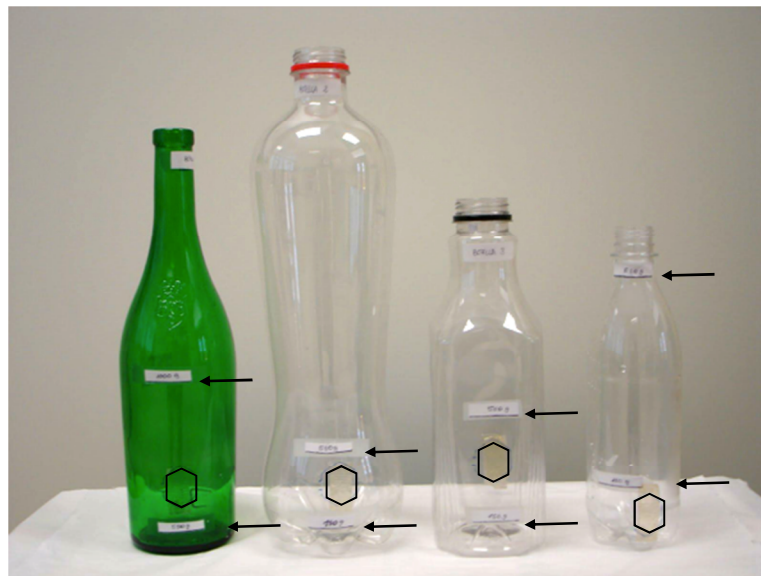
Figura 5.1: Botellas utilizadas en el experimento. De izquierda a derecha: B1, B2, B3 y B4. Se ha remarcado con un contorno la localización de los sensores de posición. Las flechas indican los dos niveles a los que se llenaban las botellas.
