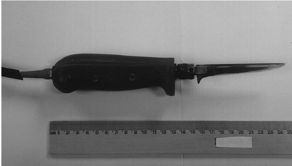
Figura 2.53: Cuchillo para medir la fuerza de corte (R. W. McGorry, 2001)
