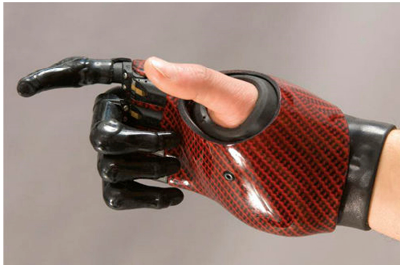
Figura 2.27: Prótesis mano parcial de mano multiarticulada y mioeléctrica (Medicallexpo, n.d.-a)
