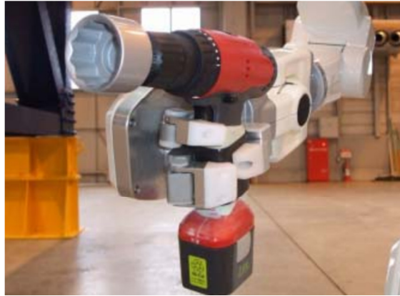
Figura 2.44: Mano del HRP-3 manejando un taladro eléctrico (Kaneko et al., 2008)
