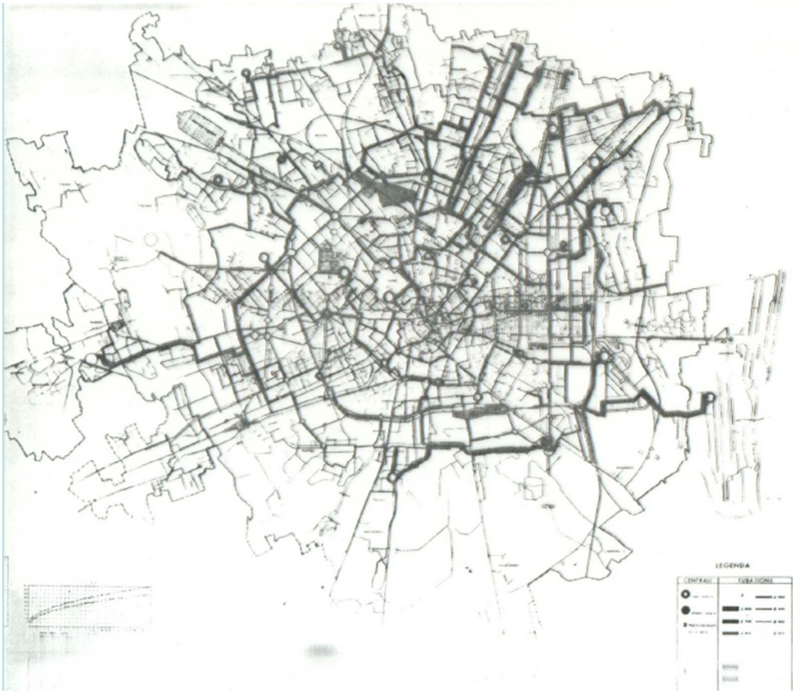
Immagine 56: Planimetria rete di distribuzione dell'acqua potabile 1930. Fonte: Poggi, 1911
