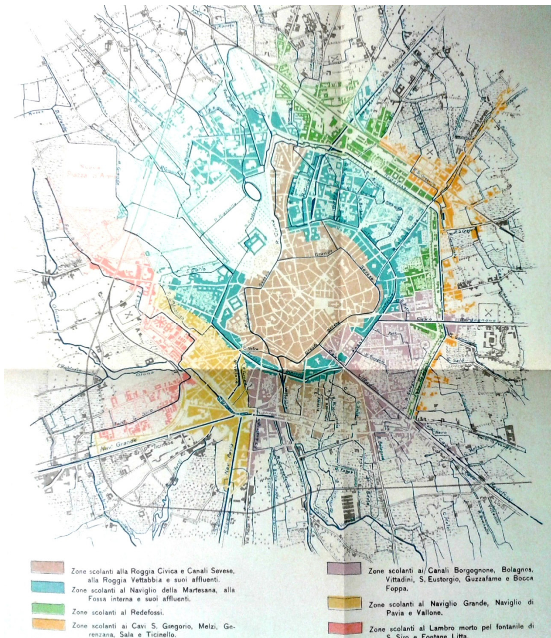
Immagine 57: Ripartimento delle zone scolanti della Città e Sobborgi antecedentemente ai lavori di fognatura. Fonte: Poggi, 1911
