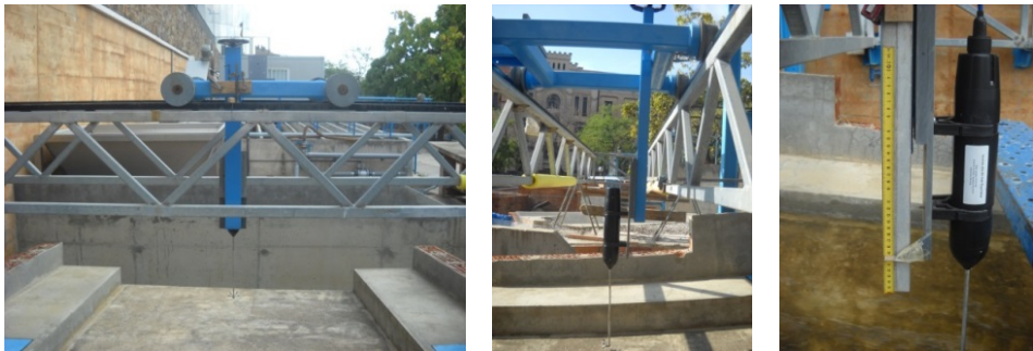
Figura III-17. Instalación del Vectrino Sidelooking en el modelo
