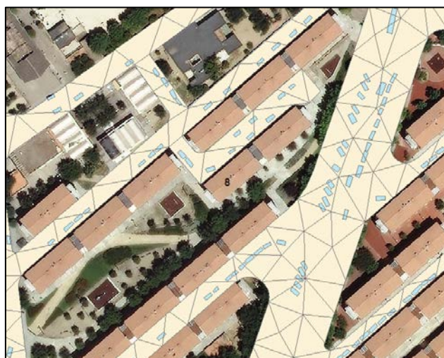
Figura VI-21. Cruce de la delimitación de vehículos con las celdas que almacenan resultados de calados
