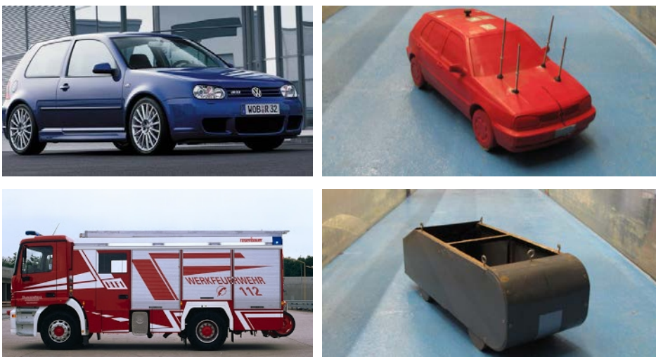
Figura II-64. Vehículos ensayados por Kramer et al. (2016). Volkswagen Golf III (arriba) y vehículo de emergencias LF 10/6. Prototipos a la izquierda y modelo a la derecha
