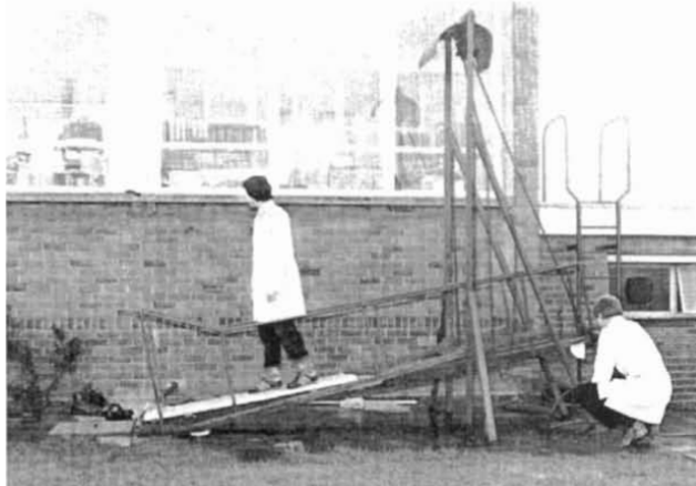
Figura V-44. Test de rampa SATRA para determinar el rozamiento entre la suela del zapato y diferentes superficies, llevado a cabo por Wilson et al. (1985)
