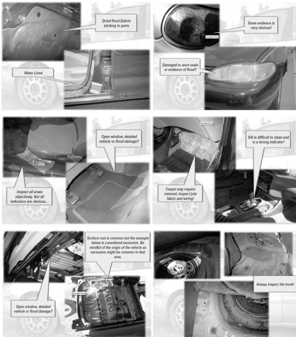
Figura II-80. Indicadores de que un vehículo ha sido dañado por una inundación. Fuente: National Auto Auction Association
