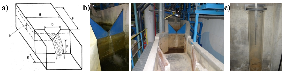
Figura IV-23. Esquema de un vertedero triangular (a), vertedero real (b) y limnómetro (c)
