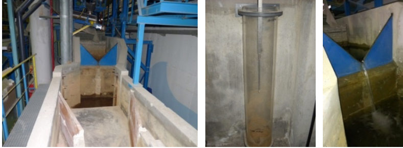
Figura IV-7. Vertedero triangular y limnómetro
