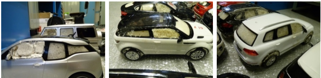
Figura IV-21. Algunos vehículos a escala rellenos de espuma ligera
