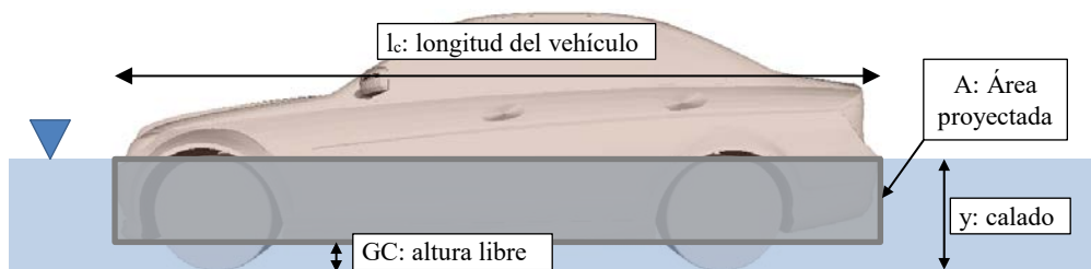
Figura V-80. Aproximación del área proyectada del vehículo con respecto la dirección principal del flujo
