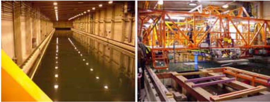
Figura II-15. Canal (denominado en el estudio como modelo de cuenca) (izquierda) y carro de remolque (derecha) de la Universidad de Helsinki (Karvonen et al. , 2000)
