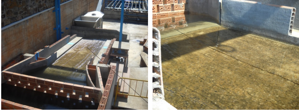
Figura III-4. Modelo físico de calle. Entrada uniforme de 100 l/s de caudal
