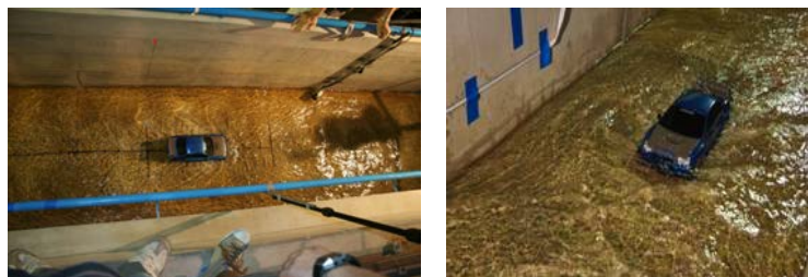
Figura II-59. Ensayo con la maqueta del vehículo tipo sedán. (Toda et al. , 2013)
