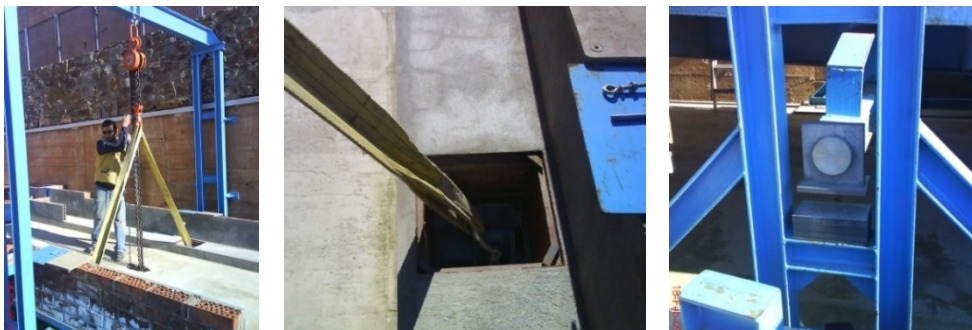
Figura III-9. Sistema de variación de la pendiente longitudinal de la plataforma
