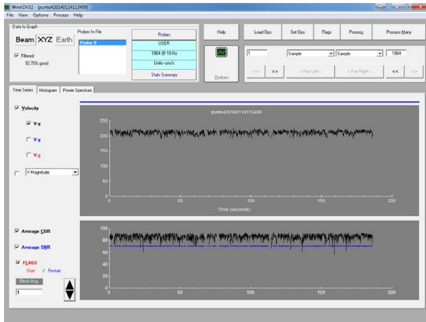
Figura III-16. Interfaz del programa WinADV. Ejemplo de registro de velocidades durante 180 segundos.
