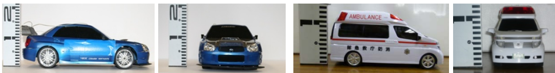
Figura II-58. Maquetas de vehículos usados por Toda et al. (2013) en sus ensayos. Tipo sedán a la izquierda y tipo furgoneta a la derecha
