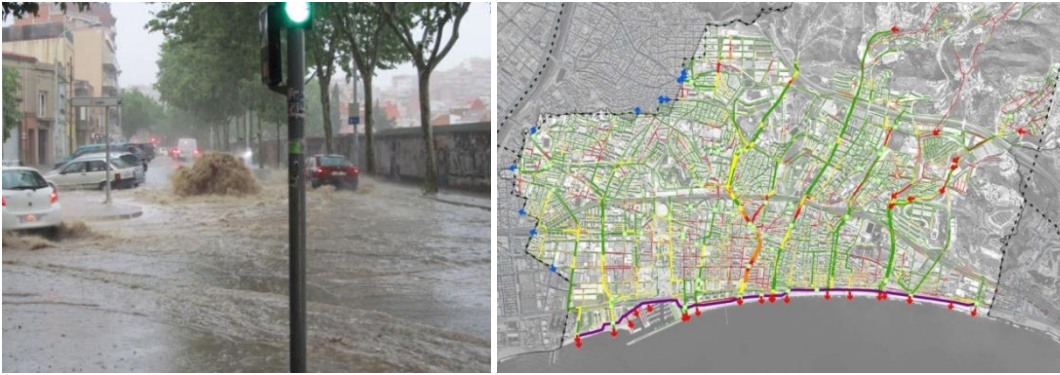
Figura VI-4. Inundación producida tras un fuerte evento de lluvia por falta de capacidad de la red de drenaje (izquierda). Comportamiento hidráulico del sistema de drenaje indicando en rojo las conducciones con sobrecarga (derecha)
