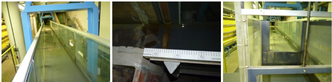
Figura IV-5. Canal de pendiente variable
