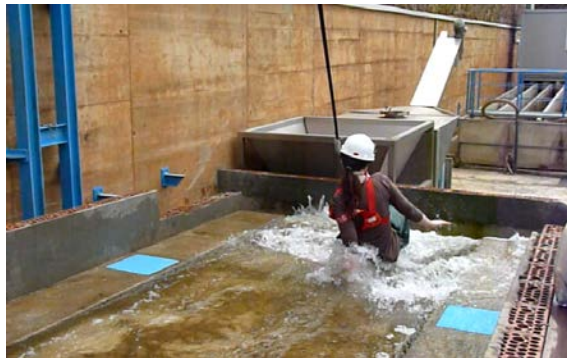
Figura V-35. Perdida de estabilidad del sujeto ensayado, para 4% de pendiente longitudinal y un caudal de 450 l/s
