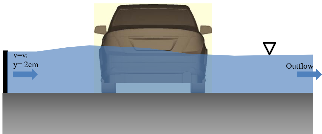
Figura V-62. Esquema del modelo para evaluar la fuerza de empuje vertical como combinación de fuerza de flotación y de ascensión
