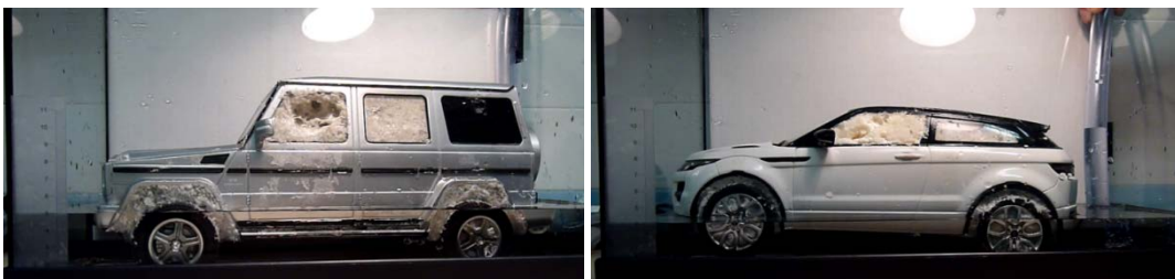
Figura IV-30. Ejemplo de ensayos de inestabilidad por flotación
