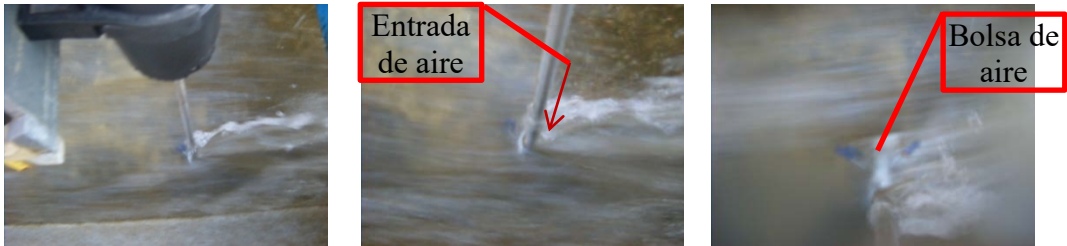
Figura III-27. Entrada de aire en las antenas receptoras para altas velocidades de flujo
