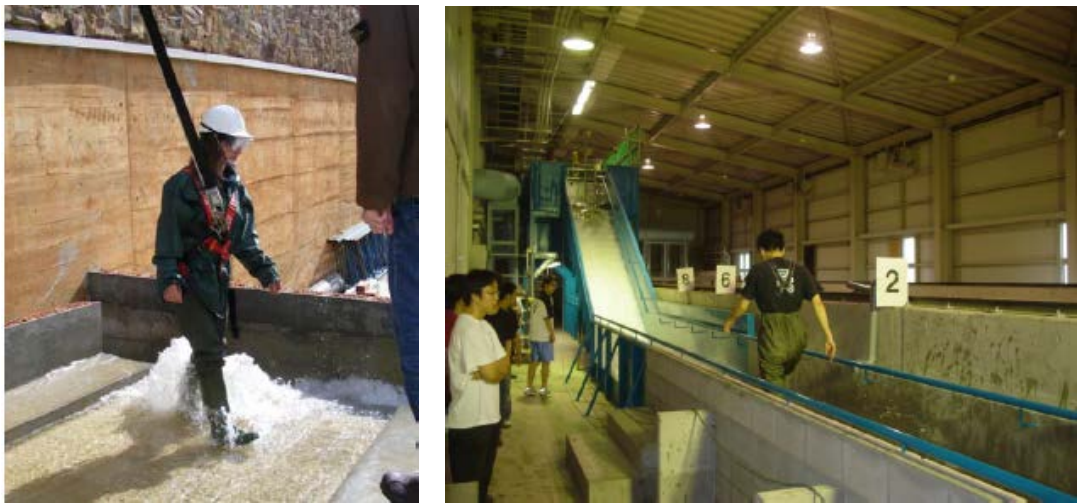
Figura I-10. Modelo de ensayos de inundación en superficie urbana, Russo (2009) (izquierda) y en zona subterránea, Ishigaki et al. (2008) (derecha)
