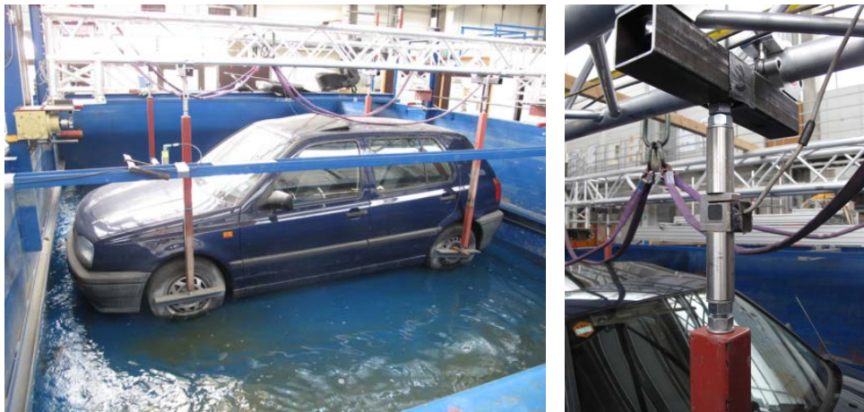
Figura II-67. Ensayo experimental para evaluar el calado de flotación de un vehículo real. (Kramer et al. , 2016)
