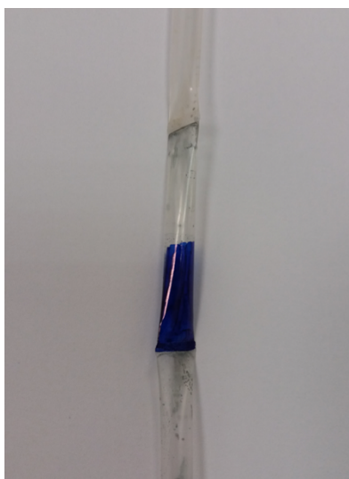
Figura 4.6 Tubo sellado para medidas magnéticas del ferricinio en solución de acetona.
