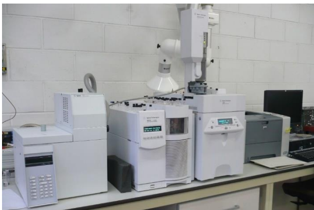
Figure 2.4 Chromatograph Agilent (6850 model with HP-5MS column) coupled to a Mass Spectrometer Agilent (model 5975C). Laboratory of Centre de Restauració de Béns Mobles de Catalunya CRBMC.
