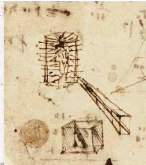
△616. El Finitotium de Alberti, Leon Battista Alberti, 1466. Medidor de puntos de escultura
