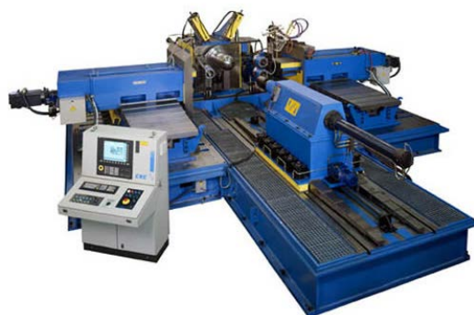
Figura 1.3. Torn de repulsar. Un motor independent per cada eix. Font: Industries Puigjaner S.A.
