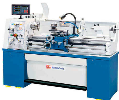
Figura 1.2. Torn de mecanitzar. Un sol motor en tota la màquina. Font: KNUTH Machine tools.
