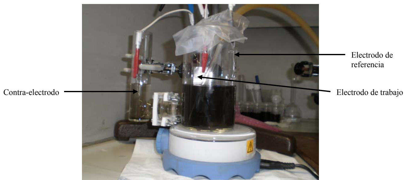
Figura 2.4 Configuración de la voltametría de barrido lineal de los polvos híbridos de polímero- \text{IrO}_x .
