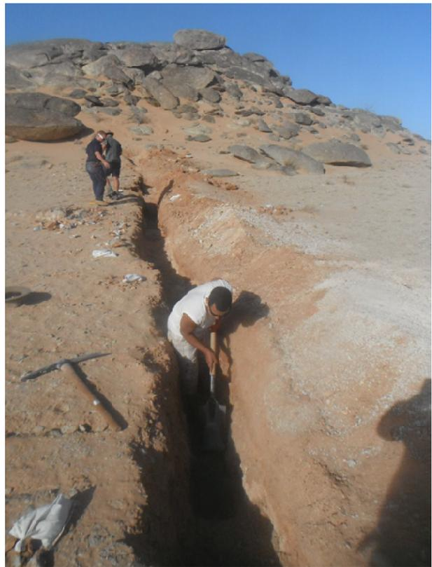
*Figura 6.5.97. Labores de reconocimiento minero mediante trincheras realizadas por Hanno Resources sobre un filón de cuarzo de espesor métrico y su zona de alteración hidrotermal en Agarazraz Labiad. Abril de 2012.*
