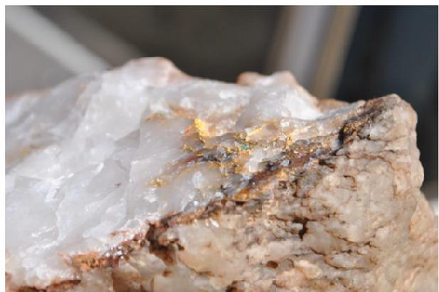
*Figura 6.5.98. Muestra de mano con oro visible en cuarzo lechoso de un filón aflorando al sur de los montes de Agarazraz Labiad. Ancho de la imagen, 5 cm.*
