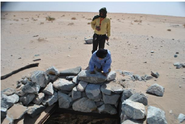
*Figura 6.1.82. Fragmentos de granodioritas frescas extraídos del pozo de Bir Malhat. Nótese la ausencia de rocas frescas en superficie.*
