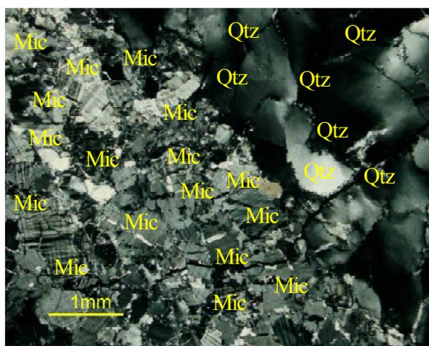
Figura 4.2.73. La imagen anterior en nicóles cruzados. A remarcar la extinción ondulante del cuarzo por deformación.
