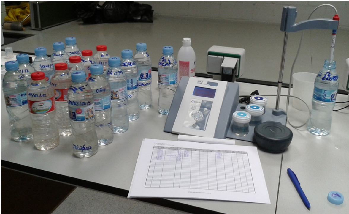
Figura 4.1. Mesura de la conductivitat elèctrica de les mostres al Laboratori de Geografia Física de la Universitat de Barcelona, març de 2012. Fotografia d'Elena Rallo.
