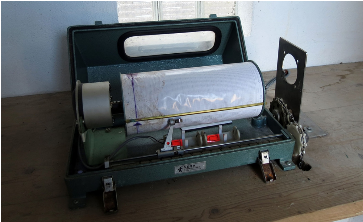
Figura 6.1. Limnigraf en desús a l'estació d'aforament de Jorba, febrer de 2012. Fotografia d'Elena Rallo.
