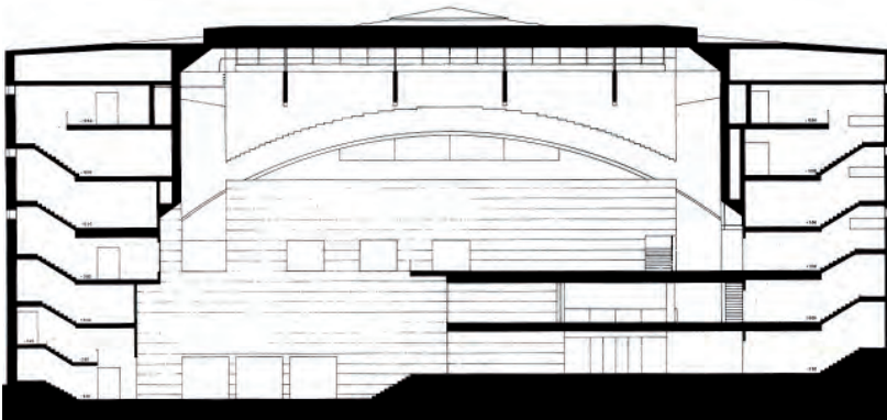
F.55. Juan Navarro Baldeweg. Palacio de exposiciones y congresos de Salamanca (1985-1992). Sección longitudinal por el triple espacio. NAVARRO BALDEWEG, Juan: Juan Navarro Baldeweg: 1982-1992 . Madrid: El Croquis, nº 54, 1992, p. 114
