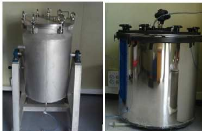
Figura 3.7 Reactores de 50 L de acero inoxidable
