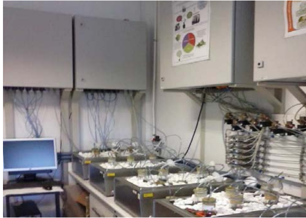
Figura 3.3 Reactores de 500 ml sumergidos en baños termostatzados y sistema de control y cálculo en función de la concentración de oxígeno (sOUR, AT 4 ) y temperatura
