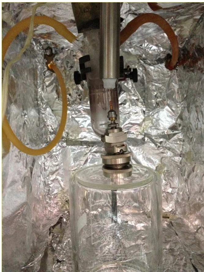
**Figura 27.** Montaje utilizado para la conversión fotoquímica de **148** a **149** en estado sólido.
