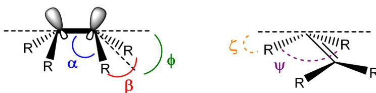
**Figura 4.** Representación de un alqueno piramidalizado y de los ángulos  $\phi$  y  $\psi$ .
