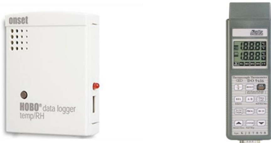
Figura 2.3. Data logger y termohigrómetro portátil utilizados durante los muestreos para los registros de temperatura y humedad ambientales y en la interfaz cebo-suelo.
