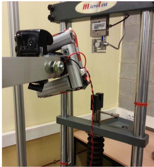
Fig 3.21. Máquina de tracción y sistema de captación.
