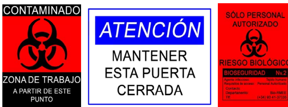
Fig 3.9. Señalización para delimitar las zonas de trabajo, y el riesgo asociado.
