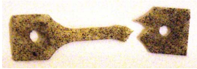
Fig 3.18. Probeta dañada por exceso de presión de la mordaza
