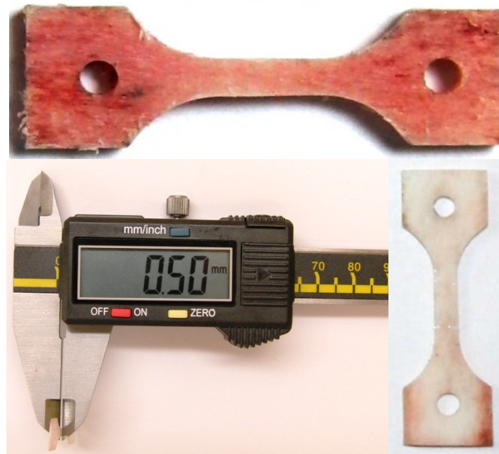
Fig 3.15. Pulido de la probeta hasta obtener su grosor nominal.
