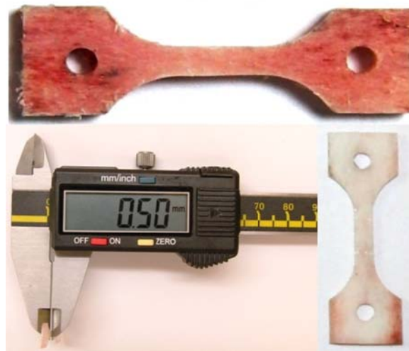
Fig 3.15. Pulido de la probeta hasta obtener su grosor nominal.
