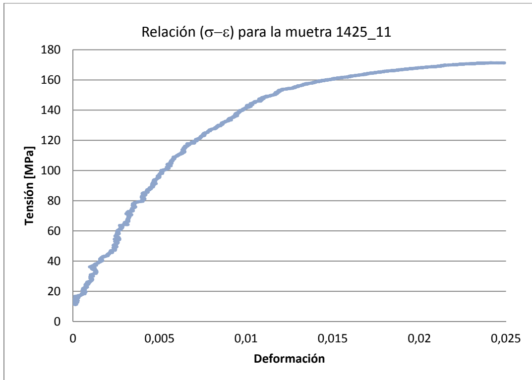
Fig 4.1. Ejemplo de resultados obtenidos, sin filtrado de datos y suavizado de la curva, relación \sigma - \epsilon para la muestra 1425_11.
