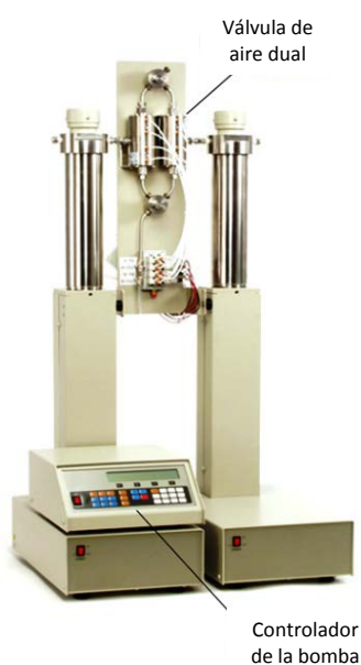
Figura 3.9. Bomba de doble jeringa de alta presión y precisión ISCO
