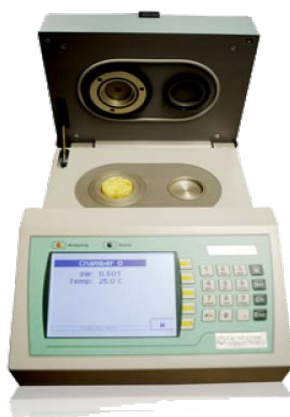
Figura 3.15 Termohigrómetro eléctrico LabMaster-aw
