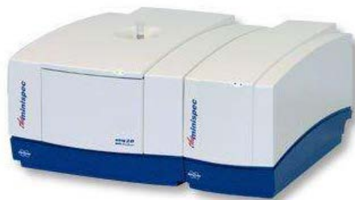
Figura 3.18. Equipo de resonancia magnética nuclear de bajo campo Minispec mq 20 analyzer
