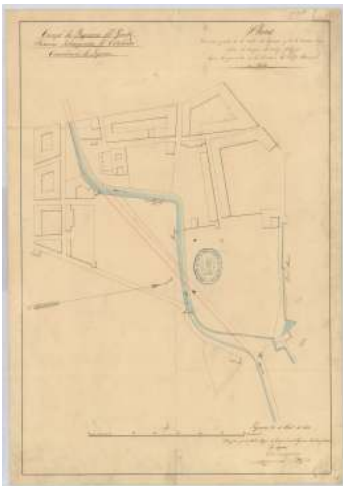
Imatge 3. Plànol de canalització d'aigües. Plano de una parte de la villa de Figueras y de los terrenos inmediatos al desagüe del arroyo Galligans / Cuerpo de Yngenieros del Ejército, Direccion Subinspeccion
