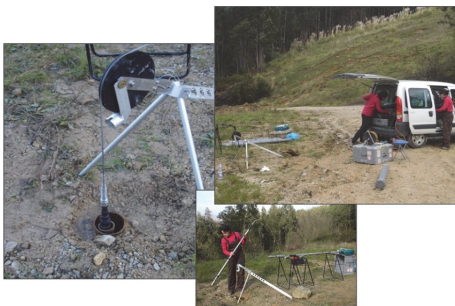
Figura A2- 5. Fotografías realizada durante la testificación geofísica del sondeo SD-4, localizado en Gijón (Asturias).
