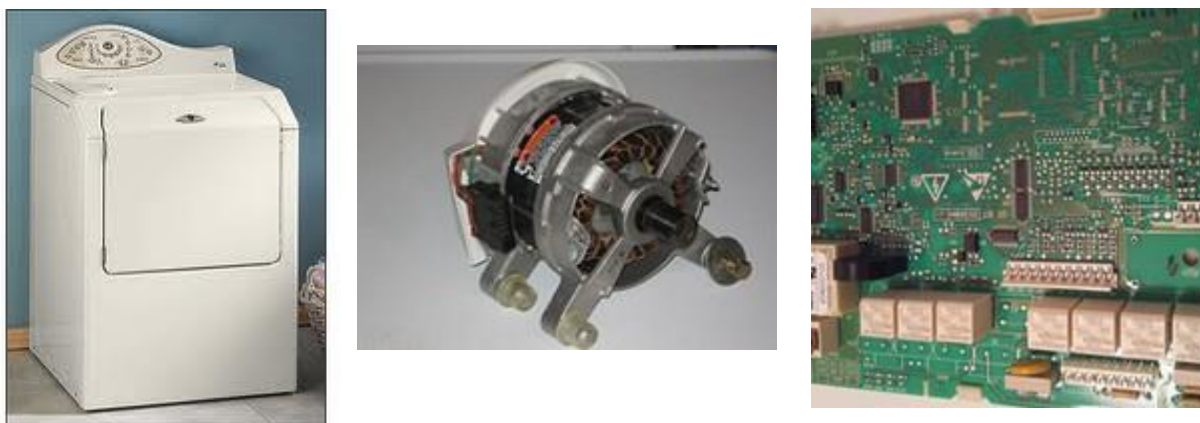
Figura 3.34. Lavadora Maytag Neptune que trabaja con un motor SRM. A la derecha, la tarjeta de control de la lavadora.
