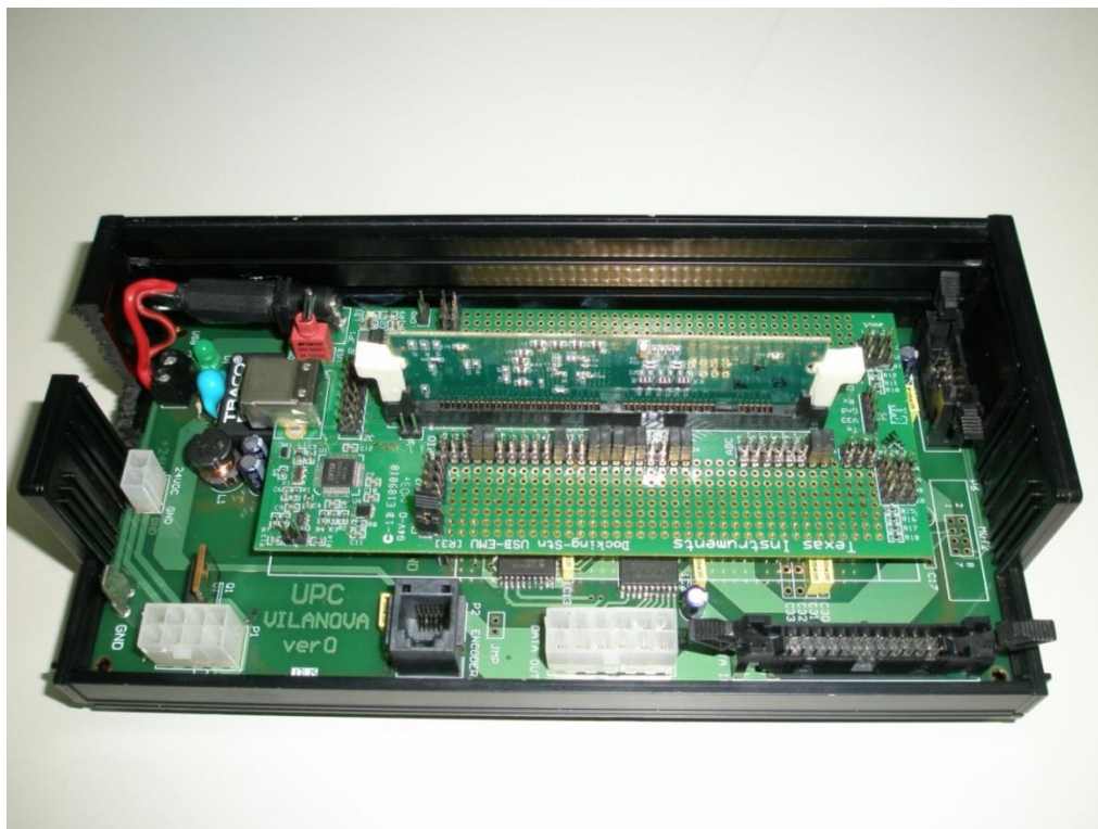
Figura 10.8. Tarjeta controladora DSC-UPC Vilanova ver0.
