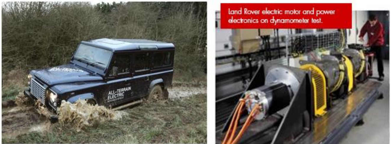
Figura 3.36. Nuevo LandRover 2013 totalmente eléctrico con motor SRM de SR drive. A la derecha, banco de pruebas del motor SRM con 330 N.m. de par máximo durante unas pruebas de ensayo.
