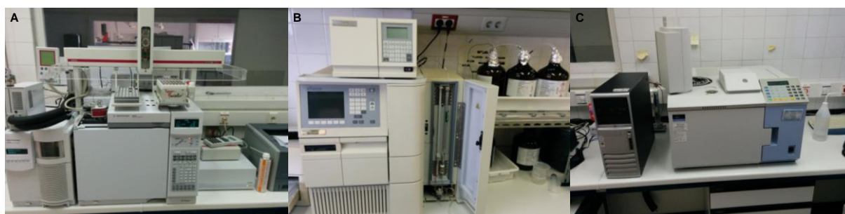
Figura 3.2. Diferentes cromatógrafos empleados en esta tesis, ubicados en el COMU. A) GC-MS, B) HPLC-Fluorescencia, C) GC-ECD.
