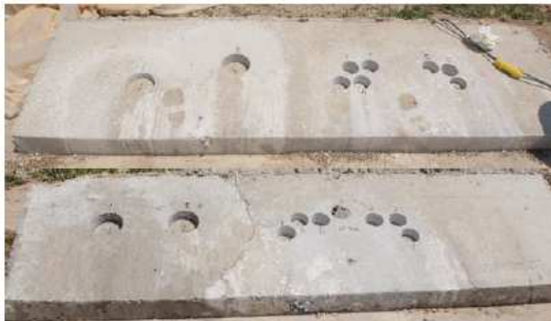
Figura 1. Ubicación extracciones A (sup.) y B (inf., tomada previamente a las dos últimas extracciones) en fragmento de New Jersey.
