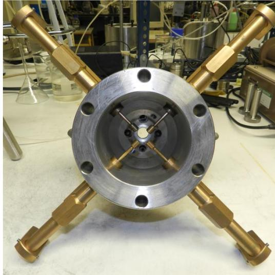
**Figura 3.9. Disposición de palpadores radiales en la campana de la célula (vista desde la base de la campana).**
