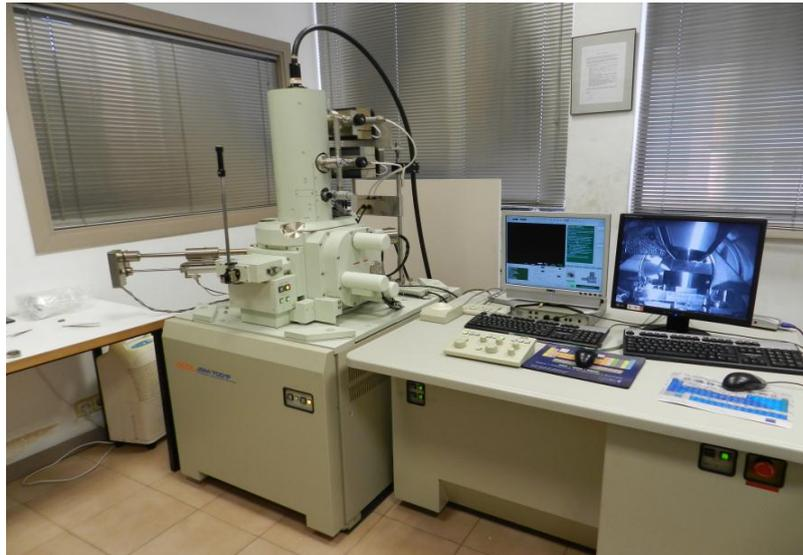
Figura 4.11. Microscopio electrónico de barrido de emisión de campo (FESEM).
