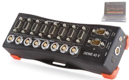
Figura 3.46. Sistema de adquisición de datos DEWE43 (DEWE43 Technical reference manual 2012).
