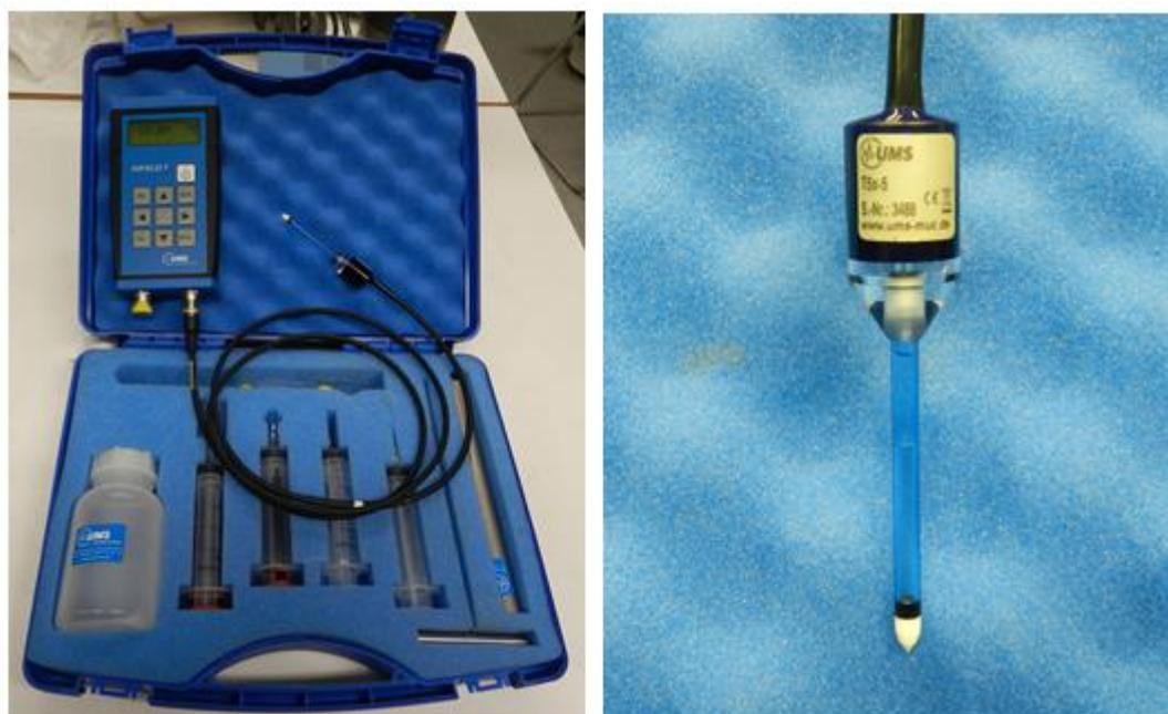
Figura D3. Tensiómetro T5x-5.
