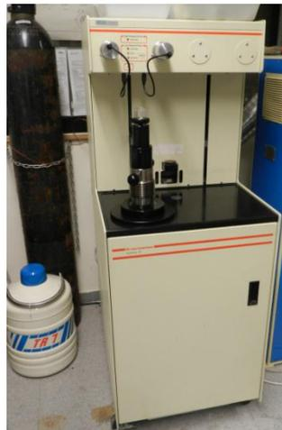
**Figura 4.9. Porosímetro Autopore IV 9500.**
