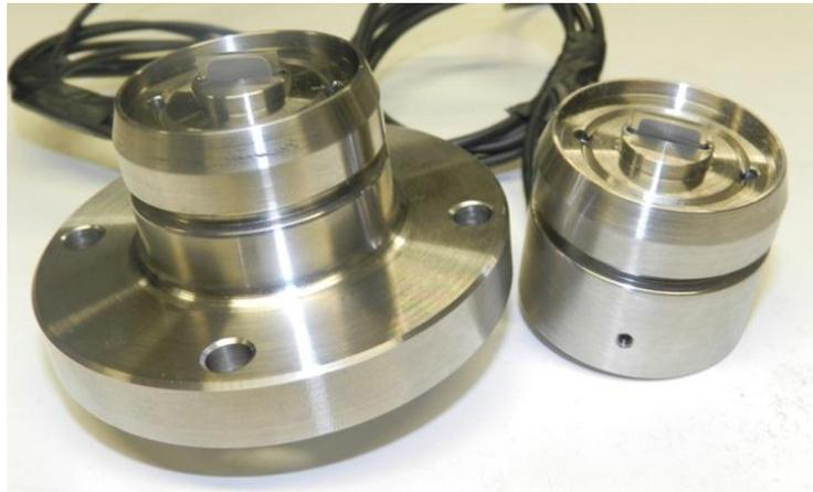
Figura 3.38. Pedestal y cabezal para el alojamiento a los *bender elements*.
