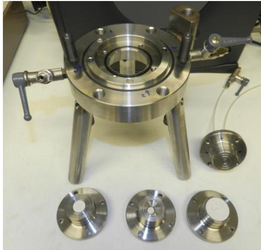
**Figura 3.4. Base de la célula isotropa con pedestales intercambiables.**
