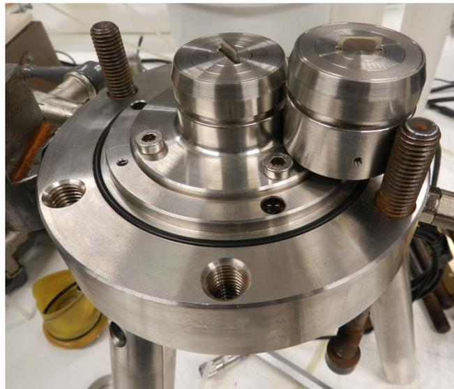
Figura 3.54. *Bender elements* alojados en pedestal y cabezal.
