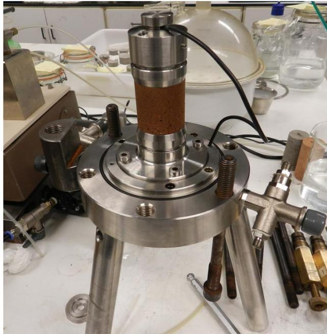
**Figura 3.56. Muestra montada para ensayo *bender element*.**
