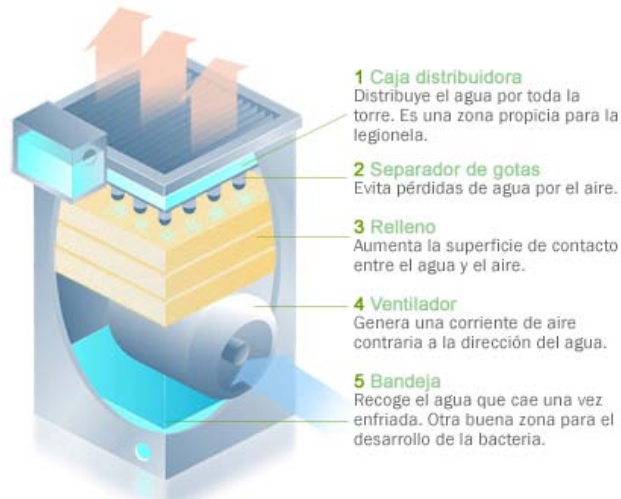
Figura 7. Esquema de una torre de refrigeración. www.athisa.es
