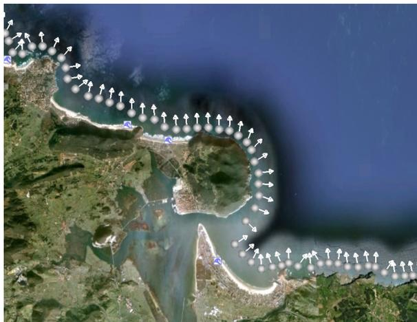
Figura 7.50. Ejemplo de los puntos seleccionados para analizar. Los vectores representan la dirección media de cada tramo de costa.
