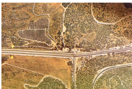
[s14] Intercanviador Sha'ar Ha-gai. Ortofoto de l'emplaçament abans i després de la construcció del nus on s'observa la desaparició de cultius tradicionals i la plantació volgudament integradora prop de la calçada.
