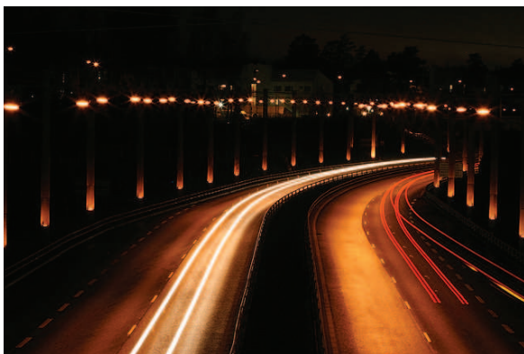
[s31] Vuosaari Gateway. L'enllumenat d'aquest tram consisteix en un sistema de lluminàries suspeses combinades amb un conjunt de petits punts de llum, més ornamentals, que simulen 132 torxes muntades als dos costats de l'autovia. Aquesta intervenció rememora a través d'una il·lusió òptica l'esdeveniment que va salvar la ciutat d'Hèlsinki dels bombardejos, quan, durant la Segona Guerra Mundial, les fogueres enceses a Vuosaari van confondre l'enemic.
