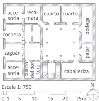
Plano de la planta baja de la casa-patio palaciega (redibujado del autor). Fuente del plano original: AGN, loc. cit.
