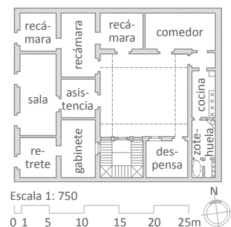
Plano de la planta alta de la casa-patio palaciega. Dibujo del autor. Fuente del plano original en el que se basa este dibujo: AGN, loc. cit.
