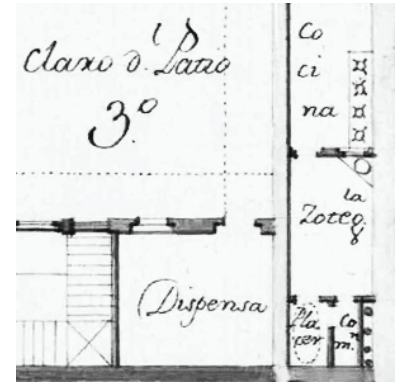
13 Detalle del plano de la planta alta de las Casas del Colegio de San Pedro y San Pablo. Se observan el placer y el común ; dentro del primero el dibujo de la bañera y dentro del segundo el dibujo de las letrinas. Fuente: AGN, loc. cit.
