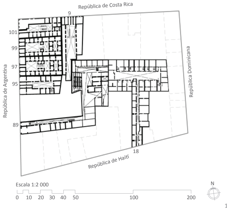
1 Esquema: Planta de la manzana urbana que se ubica entre las calles Argentina, Costa Rica, República Dominicana y Haití, donde se localizan siete edificios que coinciden con la morfología de las casas de vecindad. Dibujo del autor en base a las plantas arquitectónicas de los edificios extraídas del Catálogo Nacional de Monumentos Históricos Inmuebles del INAH [fecha de consulta: 30/08/2010]. 2 Fotografía de la fachada principal del edificio localizado en la calle Argentina nº 101. 3 Fotografía del interior del mismo edificio, Argentina nº 101. Fuente de ambas fotografías: Catálogo Nacional de Monumentos Históricos Inmuebles .
