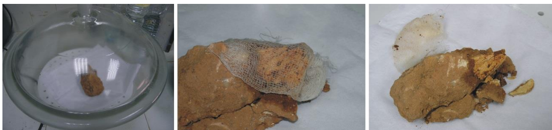
Figura 32. Desengasado con vapores de acetona.
