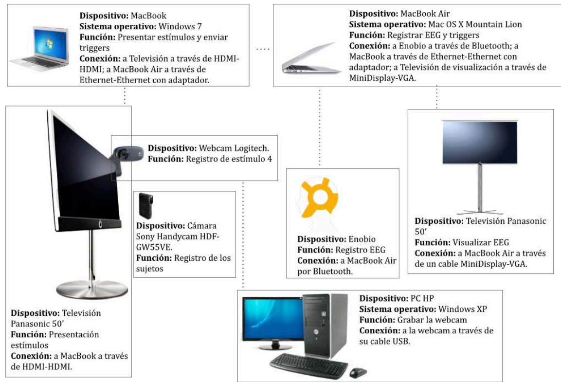
Figura 32. Mapa de conexiones de EEGLab. El laboratorio contaba con 2 televisores: uno de ellos para proyectar los estímulos a los sujetos, el otro para visualizar el registro de electroencefalografía. Se trabajó con 3 ordenadores simultáneamente: un MacBook portátil, con partición Bootcamp y sistema operativo Windows 7, presentaba los estímulos a la pantalla correspondiente, también enviaba los triggers en cada cambio de plano; otro ordenador MacBook Air con sistema operativo Mac OS X Mountain Lion, se encargaba de hacer el registro de la señal electroencefalográfica y la recepción de los eventos o triggers enviados por cada estímulo de video, este ordenador se podía visualizar en otra pantalla para mayor comodidad de los investigadores; el tercer ordenador de mesa HP con Windows XP se encargaba de registrar a través de una webcam la acción real, para su posterior sincronización y análisis de este estímulo. El laboratorio contaba con 2 cámaras: la webcam que registraba la acción real; y una cámara Sony HD que registraba la cara de los sujetos, esta información resulta útil en el análisis para comprobar qué hace el sujeto en cada momento. Finalmente, el laboratorio contaba con el dispositivo ENOBIO de registro electroencefalográfico, compuesto tanto por el casco y electrodos correspondientes como por el aparato de registro y envío de señal explicado en la sección Técnicas y métodos de recolección de datos . Fuente: elaboración propia.
