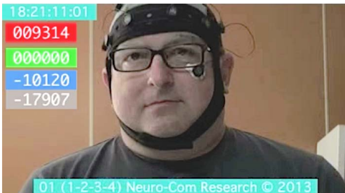
Figura 37. Imagen del registro de un sujeto. Para la gestión de las imágenes, se llevaron a cabo distintos códigos. En la parte superior izquierda, aparece en primer lugar el Tiempo Unix del registro en HH:MM:SS:FRAMES. A continuación, en rojo, aparece el contador en frames del estímulo 1; en verde se aprecia el contador del estímulo 2; en azul el contador del estímulo 3; y, finalmente, en gris, el contador del estímulo 4. En esta imagen, al encontrarse la etiqueta verde en 0000, significa que está comenzando el estímulo 2. En la parte inferior aparece el número de sujeto (01), el orden de presentación de los estímulos (1-2-3-4), y el copyright de Neuro-Com Research Group, grupo de investigación en el que se ha desarrollado este estudio y el año de su ejecución, 2013. Fuente: elaboración propia, uso con consentimiento del sujeto.
